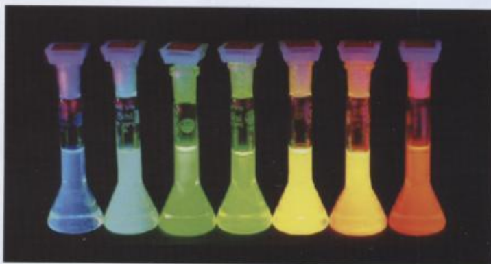
Figura 1 Imágenes fluorescentes de los puntos cuánticos de diferentes tamaños de la nanopartícula, imagen tomada de: http://www.beseenonabike.com/bsobab/beseenonabike_info_fluorescence.htm
