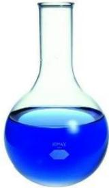
En el matraz de fondo se adiciona: dos partes de isopropanol (3.73 mL), 11.16 ml de PDMS y 4.97 ml de TEOS, se coloca en una parrilla a 90°C, durante 15 minutos. Este es el matraz uno donde se va ir adicionando los siguientes pasos.
