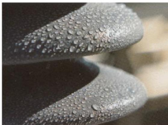
**Figura 2.4 Hidrofobicidad superficial en un aislador polimérico [20].**
