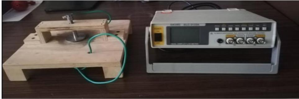
**Figura 3.8 Arreglo para la medición, Puente RLC**
