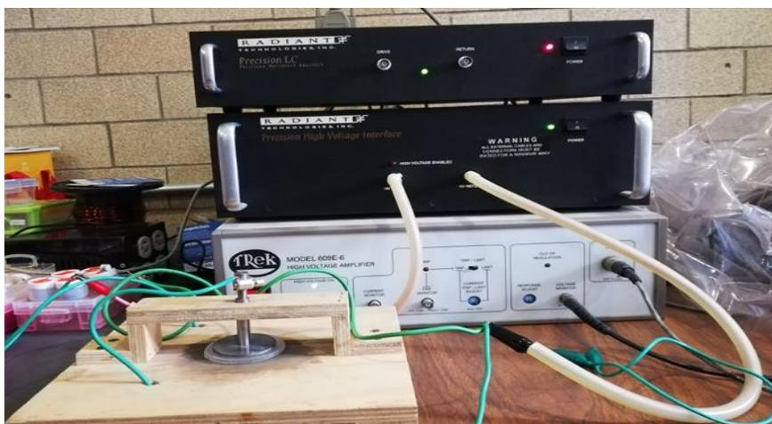
Figura 3.13 Arreglo experimental, amplificador de alto voltaje
