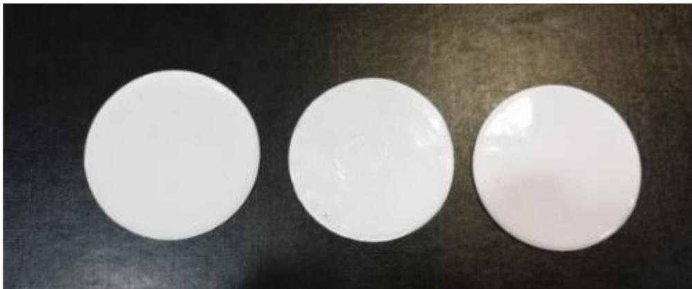
**Figura 4.2 Compósitos de hule silicón con diferente contenido de  $\text{BaTiO}_3$**
