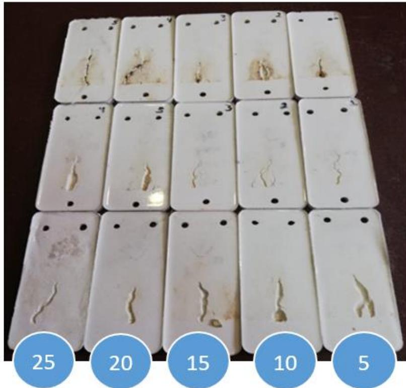
**Figura 4.13 Resultados de la prueba de plano inclinado en corriente directa, compósitos de BaTiO<sub>3</sub>**
