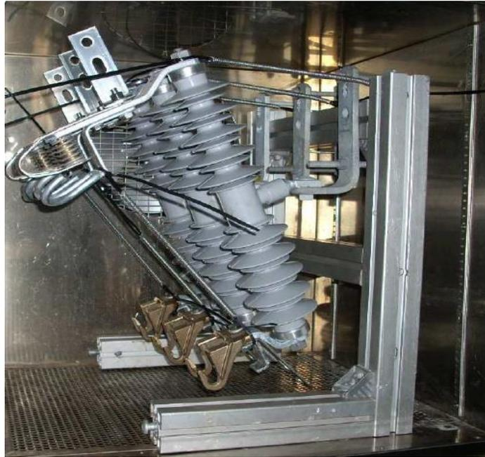
**Figura 2.17 Cámara climática, listos para comenzar ensayo termomecánico [31].**
