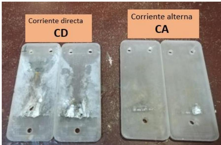
**Figura 4.19 Muestras de silicón puro sometidas a la prueba de plano inclinado. Se puede observar el tipo de daño que causó cada tipo de corriente.**
