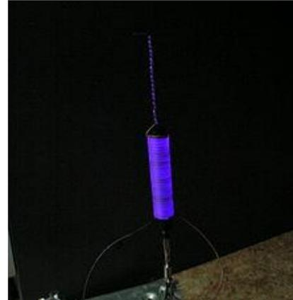
**Figura 2.6 Primer imagen descarga corona, la segunda imagen es descarga corona alrededor de una bobina de alta tensión [17].**
