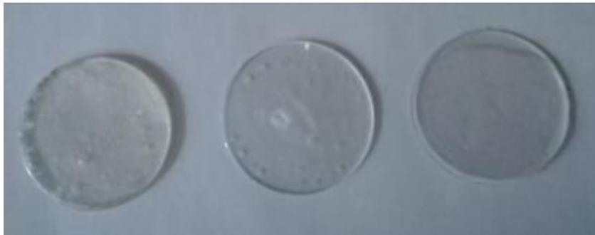
**Figura 4.1 Láminas de sol-gel de diferentes viscosidades**
