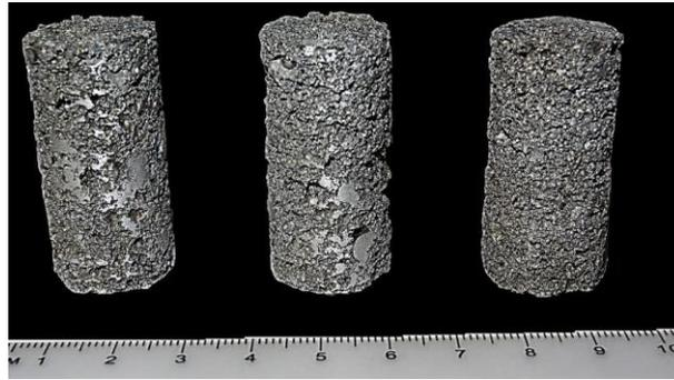
Fig. 46 Muestras cilíndricas de 19mm de diámetro y 38 mm de altura maquinadas para pruebas de compresión
