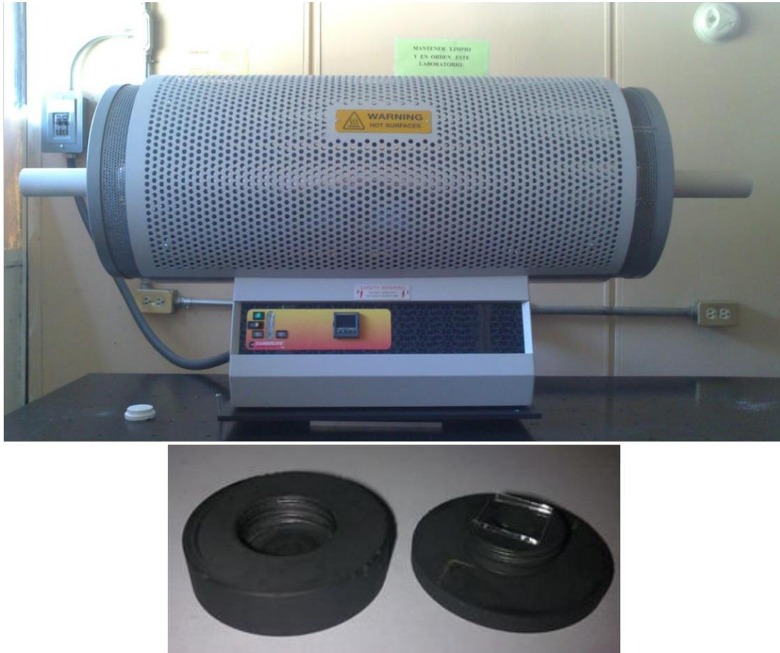
Fig. 2.1 Horno tubular Carbolite y celda semihermética de grafito
