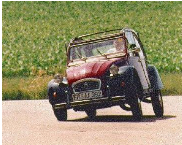
Figura 20: Efecto de fuerza en suspensión automóvil [14].
