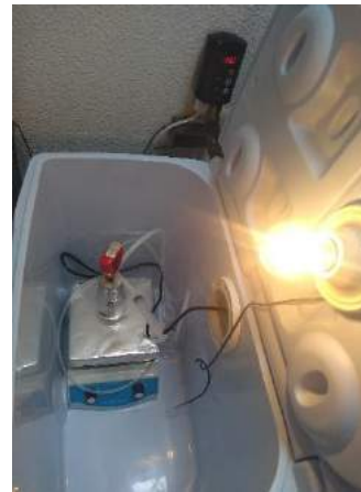
Figura 4. Incubadora que mantuvo el sistema a 37° C
