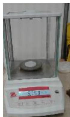
Fig. 3.11. a) Medida del espesor del disco hecha con un micrómetro, y b) peso del disco de UHMWPE realizada con una balanza analítica.
