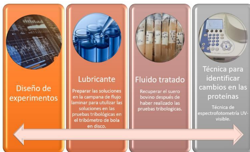
Fig. 3.2. Esquema de la metodología experimental para el biolubricante.
