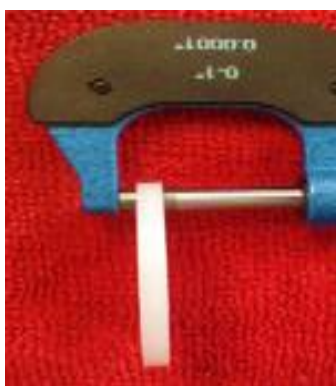
Fig. 3.11. a) Medida del espesor del disco hecha con un micrómetro, y b) peso del disco de UHMWPE realizada con una balanza analítica.
