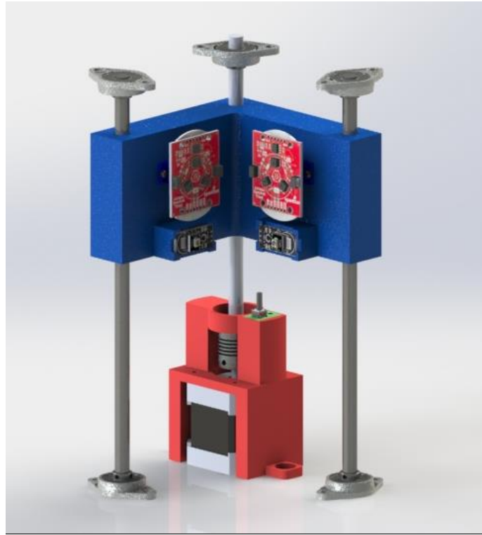
Figura 163. Mecanismo de la selección de los sensores.
