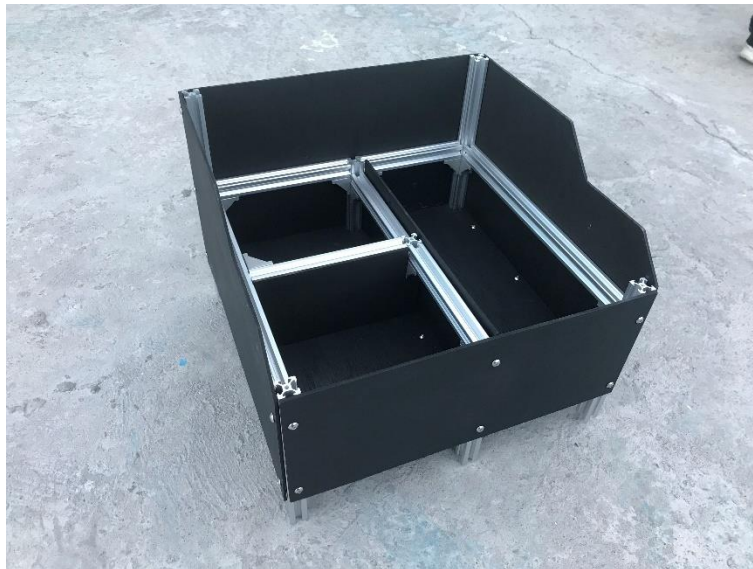
Figura 182. Ensamble de la estructura con las paredes de MDF manufacturadas.
