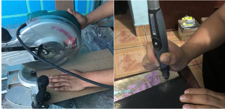
Figura 179. Proceso de corte y barrenos de la base de la estructura de MDF.
