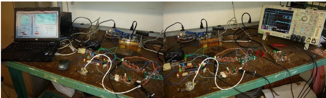
Figura 249. Conexión del circuito de barrido en frecuencias con el transductor, el software controlador y el osciloscopio
