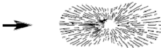
Figura 7. Partículas pequeñas de 1/10 de la longitud de onda, la dispersión es simétrica [34]
