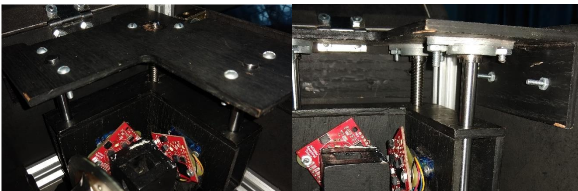
Figura 211. Soporte superior para guiar al mecanismo de posición de los receptores ópticos.
