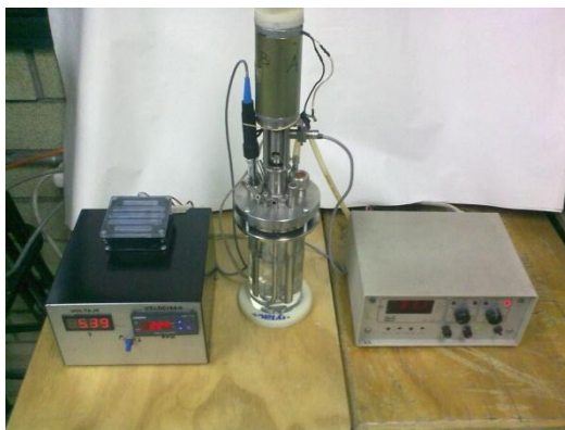
Figura 10. Determinación de la velocidad de transferencia y consumo de oxígeno en el cultivo en suspensión de J. mexicana
