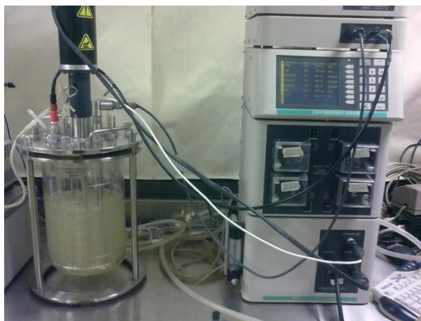
Figura 11. Biorreactor de tanque agitado de 6 L, New Brunswick Scientific Co Inc ® con cultivo de células de J. mexicana .
