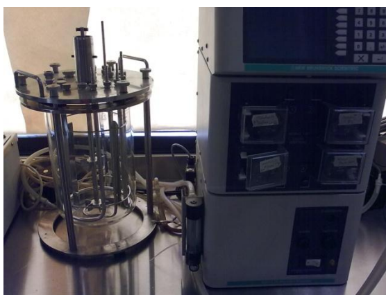
Figura 2. Biorreactor de tanque agitado de 6 L, New Brunswick Scientific Co Inc ® (New Jersey U.S.A)
