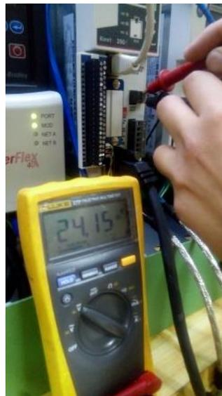
Figura. 5.7: Alimentación del Kinetix 350.
