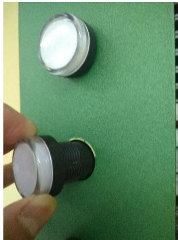
Figura 3.35: Montaje de lámparas indicadores.
