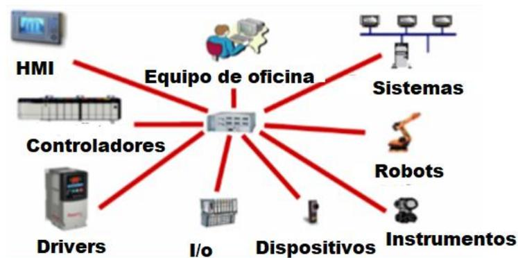
Figura 1.4: Ejemplo de red EtherNet/IP.
