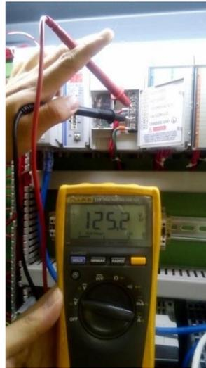
Figura 5.2: Medición de la tensión de entrada del PAC.
