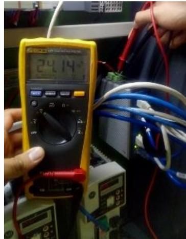
Figura 5.8: Medición de la alimentación del Switch.
