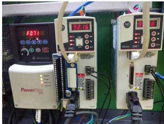
Figura 5.19: Dispositivos en falla cuando se pierde la comunicación con el puerto 1.
