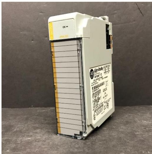
Figura 3.17: tarjeta 1769-OF8V.
