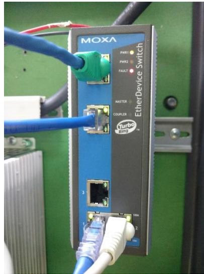
Figura 5.26: Desconexión del cable (puerto 3).
