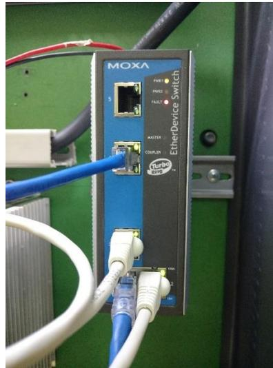
Figura 5.38: Desconexión del cable (puerto 5).
