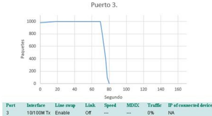
Figura 5.28: Transferencia de datos en el puerto 3 con enlace inactivo.
