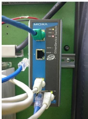
Figura 5.32: Desconexión del cable (puerto 4).
