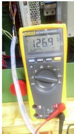
Figura 5.1: Medición de línea principal.
