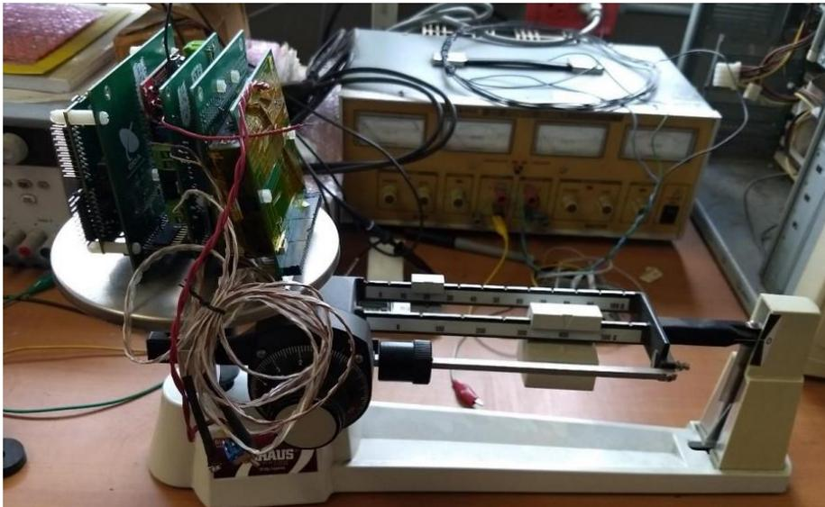
*Figura 5.5 – Pesaje de la instrumentación final (SADM 1.2 y SADM 3).*
