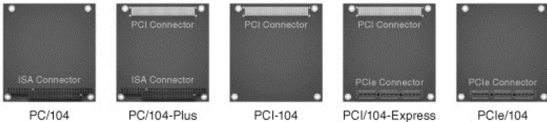
**Figura 4.2 - Tipos de conectores usados dentro del estándar PC/104. [7]**
