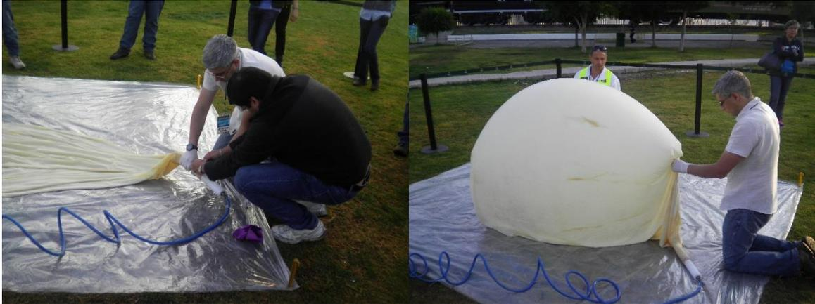
**Figura 5.19 – Proceso de llenado del globo sonda.**
