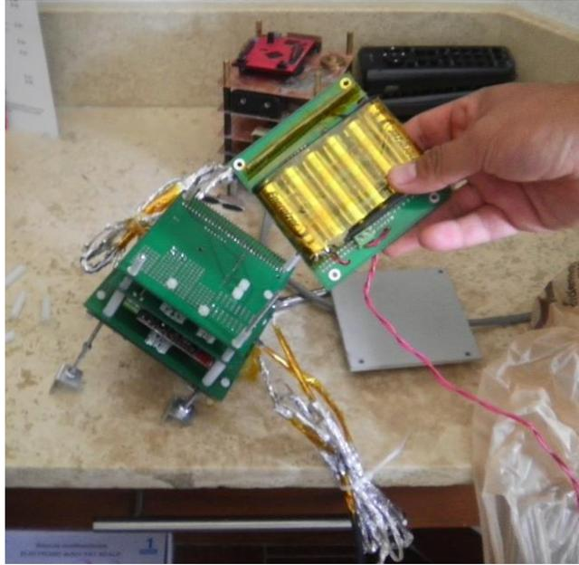
**Figura 5.6 – Instalación de baterías en SADM 1.2.**
