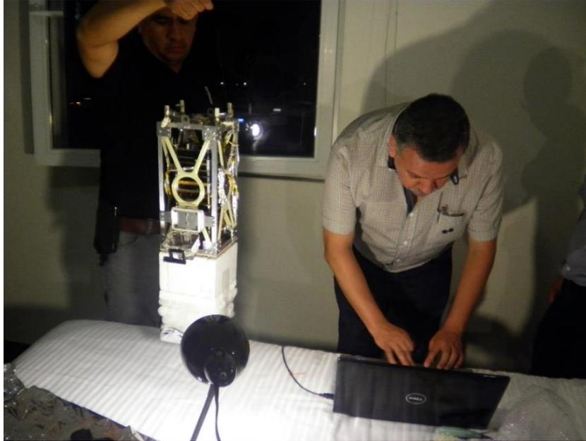
**Figura 5.13 – Prueba de funcionamiento del sistema SADM 1.2 integrado en la plataforma CSM.**
