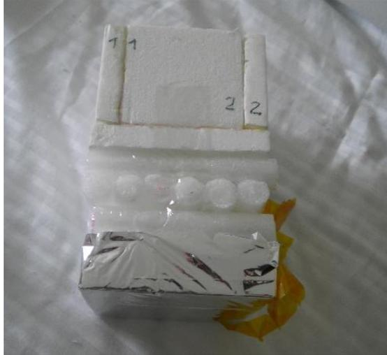
**Figura 5.11 – Base de espumados plásticos para amortiguar el impacto en aterrizaje.**
