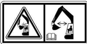
¡Peligro de aplastamiento! Algunas combinaciones del varillaje frontal de la máquina (pluma, brazo, acoplador rápido, herramienta) requieren mantener la herramienta alejada de la cabina durante la operación de la máquina. Si la herramienta entra en contacto con la cabina durante la operación de la máquina, esto puede tener por resultado lesiones personales o la muerte
