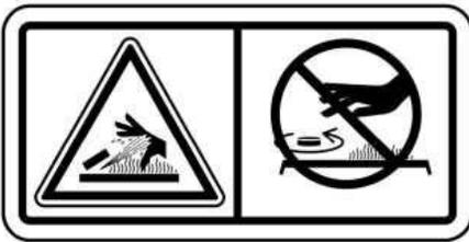
Sistema a presión: El refrigerante caliente puede causar quemaduras graves. Para quitar la tapa, pare el motor y espere hasta que el radiador esté frío. Entonces afloje la tapa lentamente para aliviar la presión.
