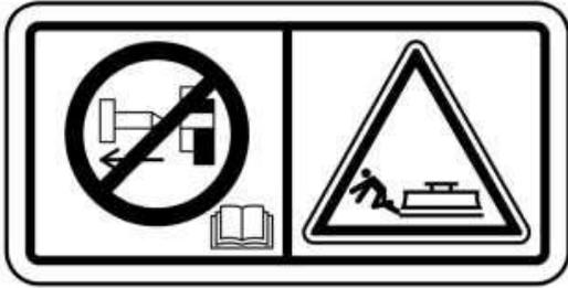
Pueden ocurrir lesiones personales como resultado del movimiento súbito de la hoja cuando se suelte el pasador de traba del desplazamiento del círculo. Para impedir el movimiento inesperado de la hoja y las posibles lesiones, baje la hoja al suelo antes de destrabar el mecanismo de desplazamiento del círculo. Vea el manual de Operación y Mantenimiento para obtener instrucciones completas antes de soltar el pasador de traba del desplazamiento del círculo.
