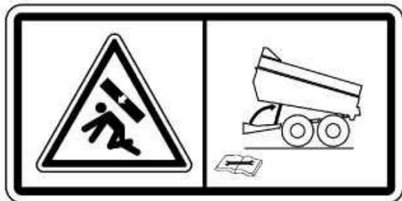
Cuando la caja volcadora esté levantada, antes de trabajar debajo de la misma, instale un puntal de apoyo para soportarla, para así evitar que ésta se caiga y dé como resultado lesiones personales o la muerte.
