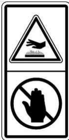
Peligro de quemaduras: Los componentes del motor pueden estar calientes durante y después de la operación de la máquina.
