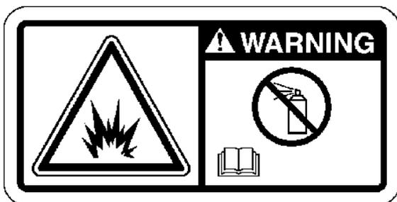
No use éter. Esta máquina está equipada con bujías incandescentes. Si usa éter podría causar una explosión o un incendio y provocar lesiones personales o mortales. Lea y siga el procedimiento de arranque del motor en el Manual de Operación y Mantenimiento.
