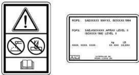
Los daños estructurales, los vuelcos, las modificaciones, las alteraciones o las reparaciones incorrectas pueden afectar la capacidad de protección de esta estructura y, por lo tanto, anular esta certificación. No suelde ni perfore la superficie. Esto anula la certificación. Consulte con su distribuidor Cat para determinar cuáles son las limitaciones de esta estructura sin anular la certificación.
