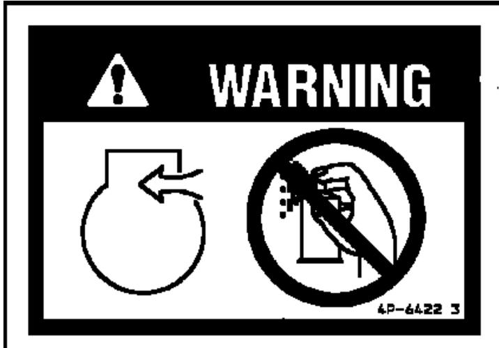
Si la máquina está equipada con un calentador en la admisión de aire (AIH) para arranques en tiempo frío, no utilice auxiliares de arranque en aerosol, como éter. El empleo de auxiliares de este tipo puede resultar en una explosión y en lesiones personales
