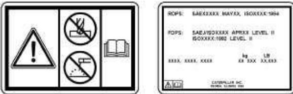
Los daños estructurales, los vuelcos, las modificaciones, las alteraciones o las reparaciones incorrectas pueden afectar la capacidad de protección de esta estructura y, por lo tanto, anular esta certificación. No suelde ni perfore la superficie. Esto anula la certificación. Consulte con su distribuidor para determinar cuáles son las limitaciones de esta estructura sin anular la certificación.
