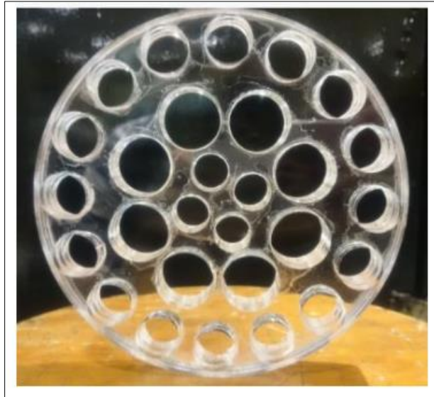
Figura 2-4 Rectificador de flujo tipo Spearman [13].
