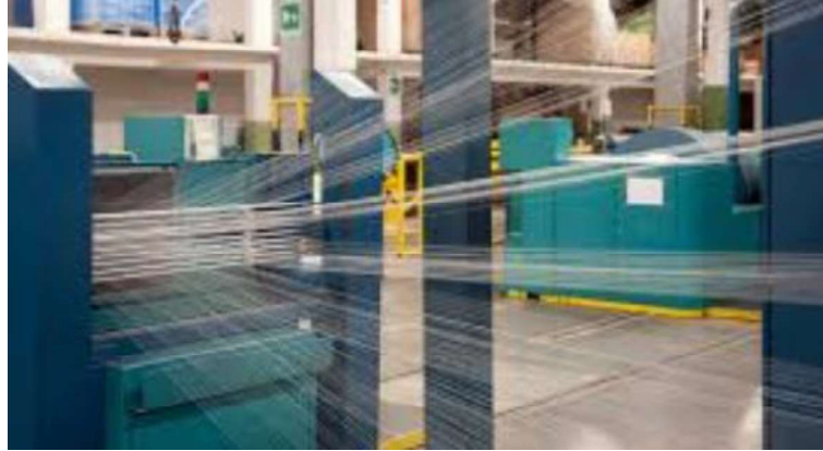
Figura 3. Urdidora de tejido plano. Derechos reservados Moreno Soppelsa, Italia, 2006.
