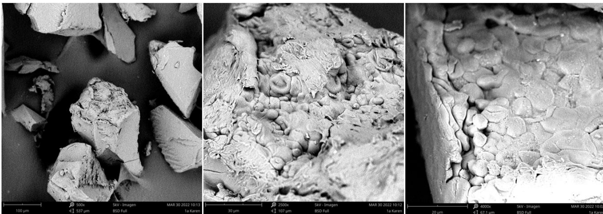
Figura 23. Microfotografías del almidón retrogradado (1:0 ARet:PEC) en polvo, enfoque de 500x, 2500x y 4000x.
