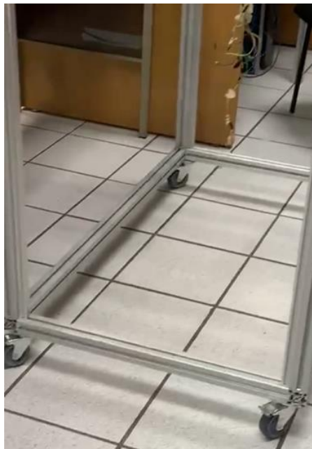
Fig. 58. Acople de las ruedas a la plataforma móvil.
