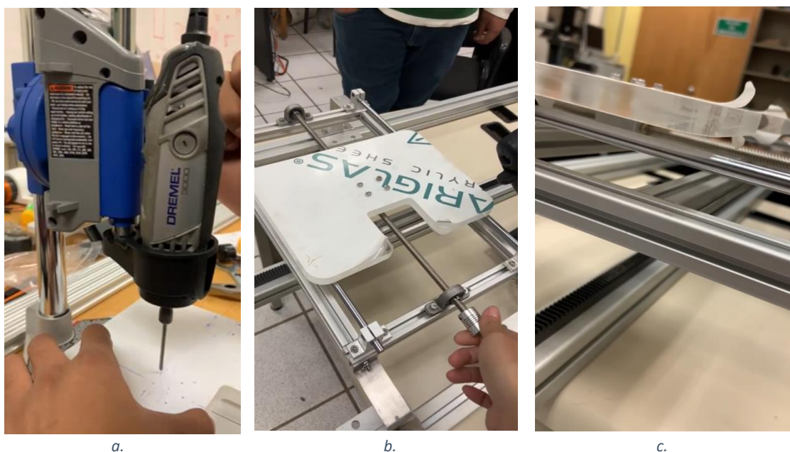
Fig. 61. a. Barrenado de la placa de acrílico. b. Placa y sistema tornillo tuerca. c. Placa empotrada.
