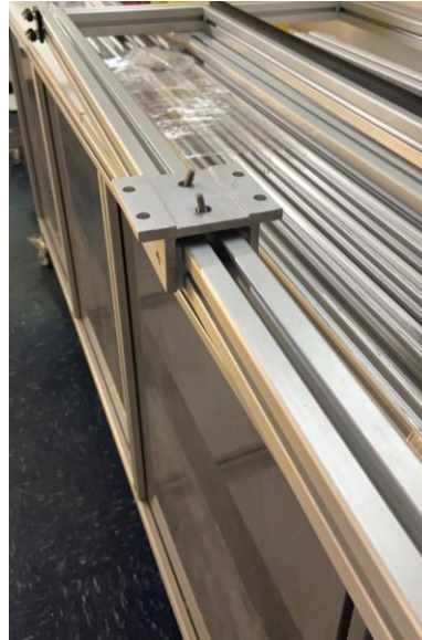
Fig. 59. Acoplamiento de las correderas y la plataforma móvil.
