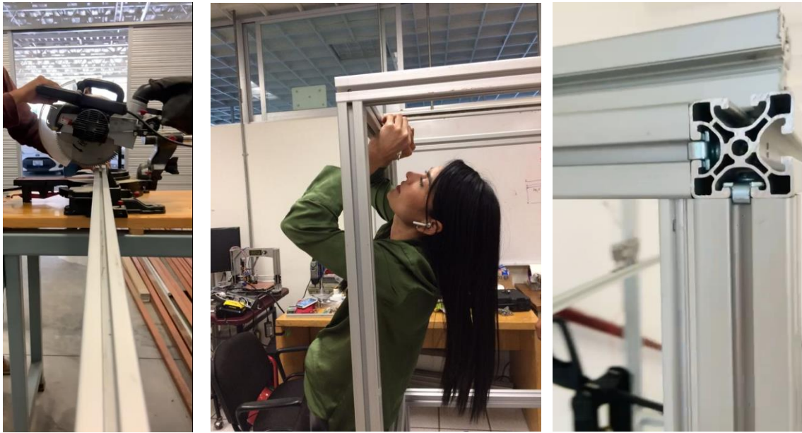
Fig. 57. Estructura móvil: a. Corte de perfiles. b. Ensamble del marco. c. Sujetadores standar para las uniones principales.
