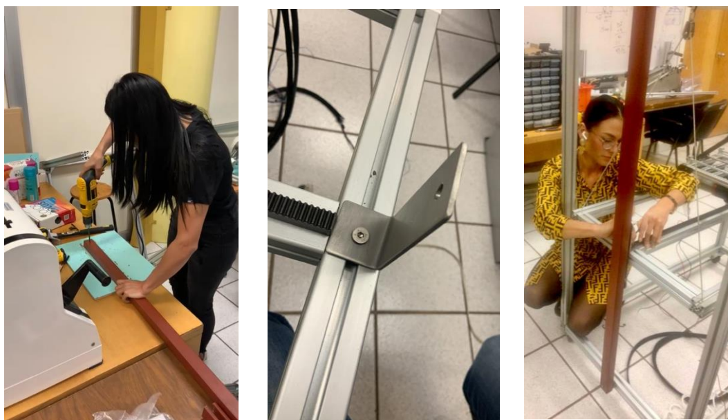
Fig. 62. Sistema de corredera: a. Barrenado del perfil en U; b. Ensamble de las placas en L; c. Acople de la plataforma móvil y sistema corredera.
