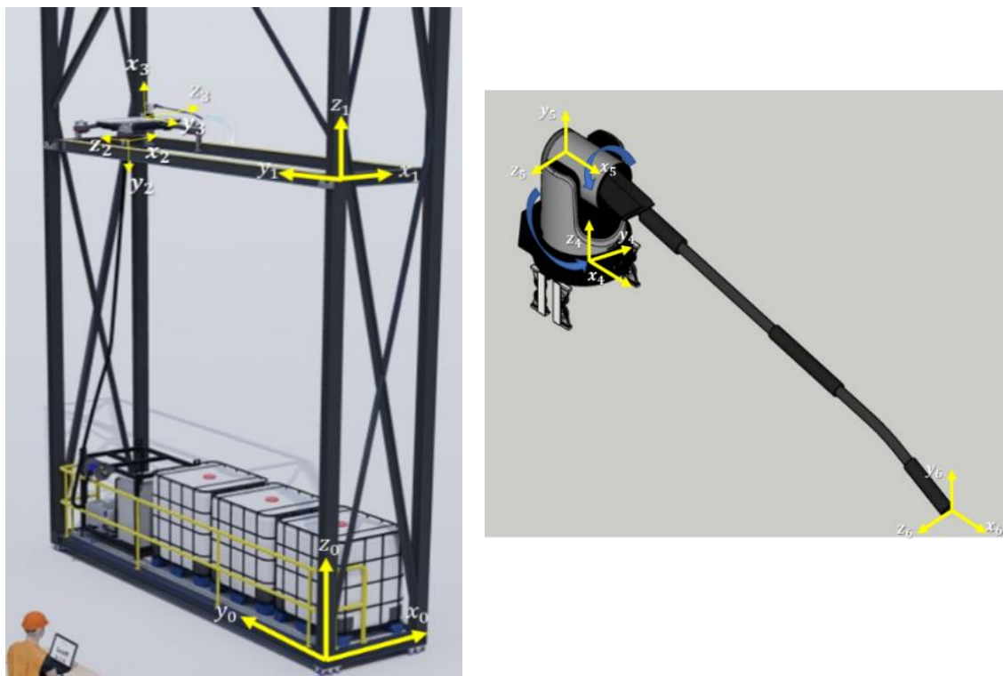
Fig. 28. Marcos: a) Estructura de tipo Cartesiano, b) Pan-Tilt y el efector final.
