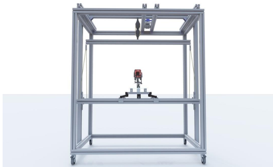
Fig. 55. Vista frontal de diseño CAD, del dispositivo con un pacómetro acoplado como efector final - Concepto modular.
