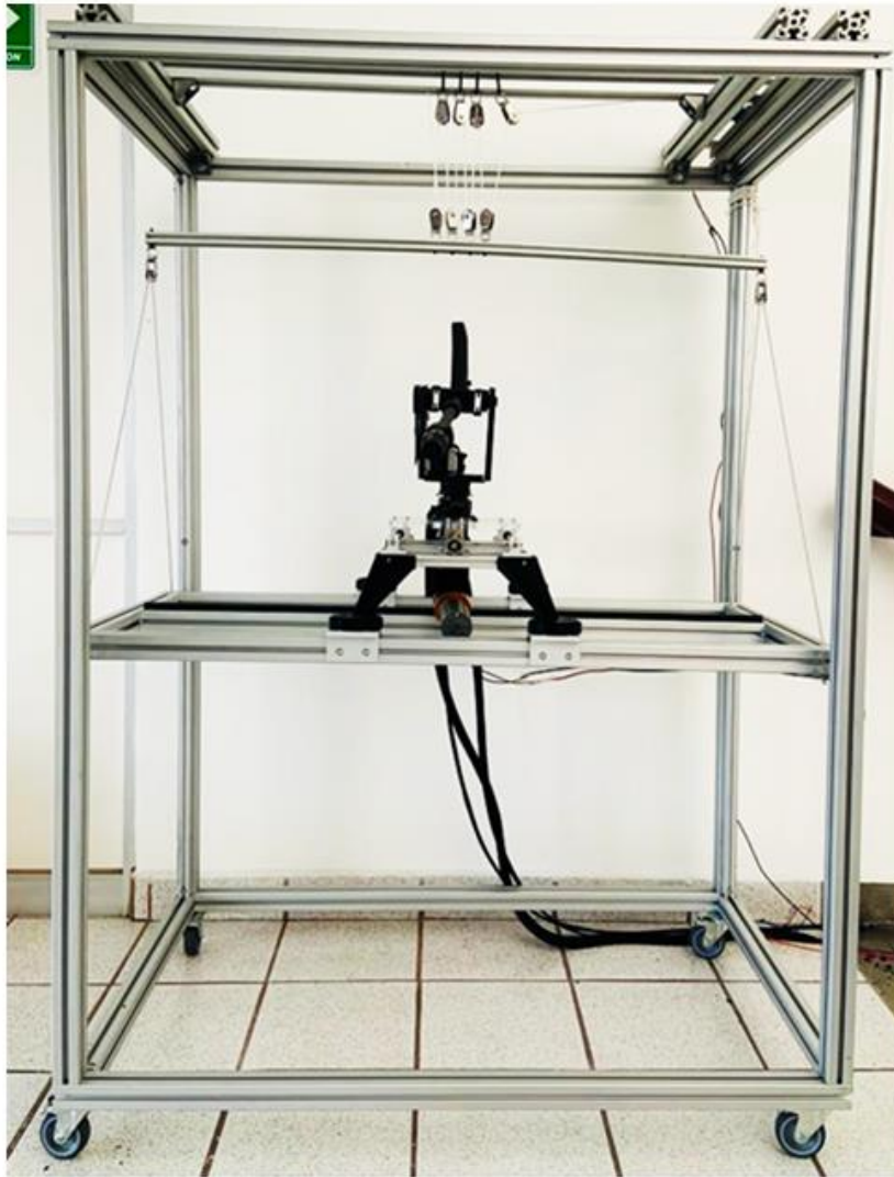
Fig. 70. a) Sistema piñón-cremallera; b) Pan-Tilt y pistola de alta presión
