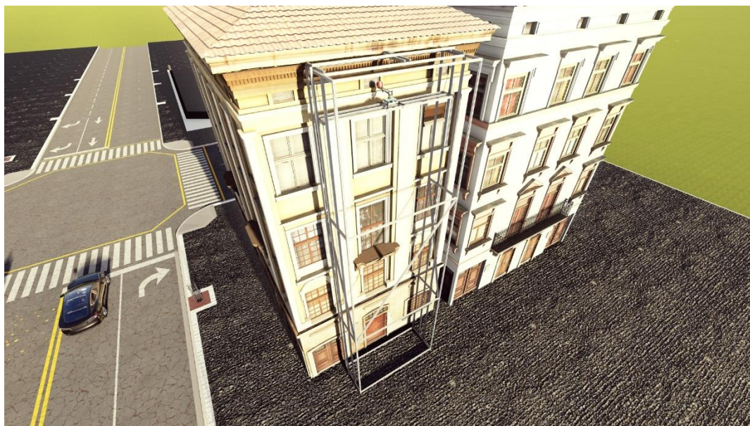
Fig. 56. Vista general de la aplicabilidad del dispositivo propuesto, utilizando el pacómetro como efector final.
