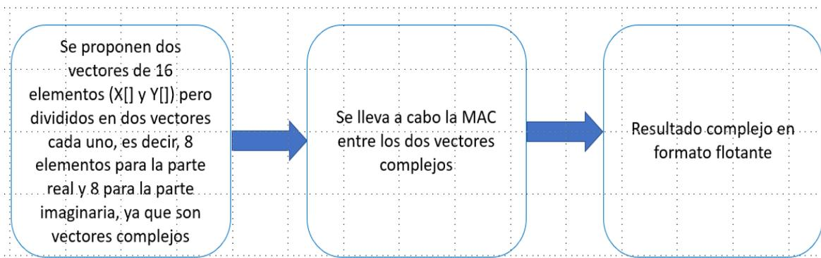
Figura 4-4: Diagrama a Bloques para realizar el paso 1-complejo.
