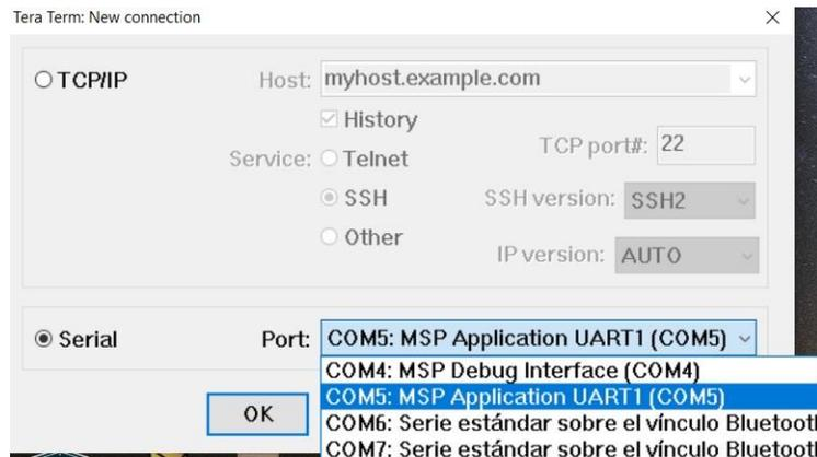
Figura 3-5: seleccionando el COM5 para poder establecer la comunicación serial en el MSP430G2553
