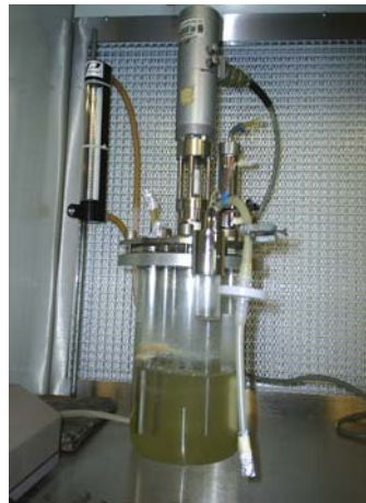
Figura 6. Tanque agitado mecánicamente
