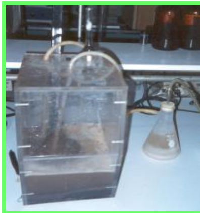
Figura 3.3 Reactor Inoculador aerobio
