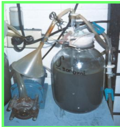
Figura 3.2 Reactor Inoculador anaerobio
