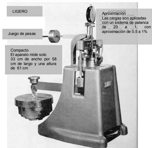
Figura 3.3 Aparato de consolidación tipo SOILTEST modelo C-220
