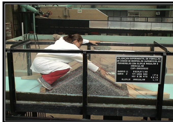
Fig. 4.1.2.3 Colocación del núcleo.
