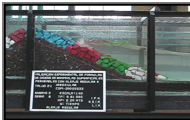
Fig. 4.6.2.1 Rompeolas Talud 2:1 Ensayo 2 Serie 8.
