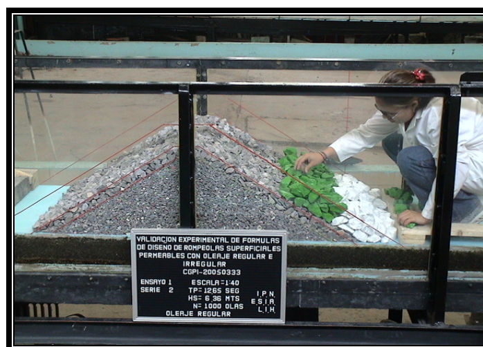
Fig. 4.1.2.4 Colocación de la capa secundaria y de coraza.
