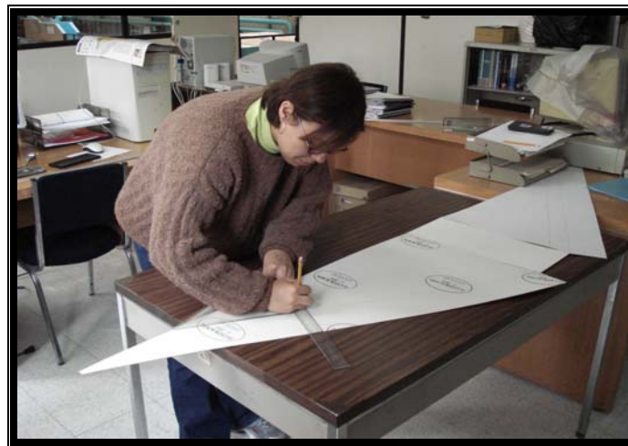
Fig. 4.1.2.1 Trazo de los escantillones.
