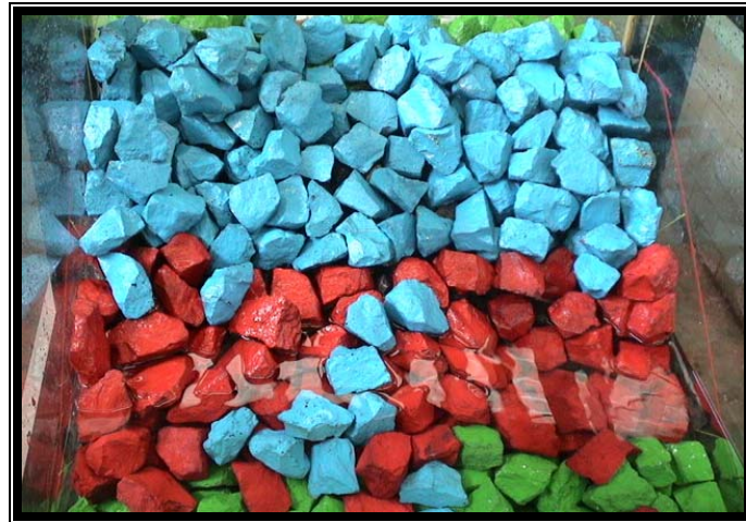
Fig. 4.6.1.1 Rompeolas Talud 1.5:1 Ensayo 2 Serie 8.
