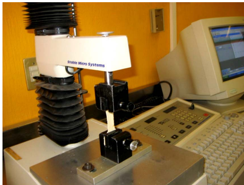
Figura 13. Prueba de resistencia a la tensión en tortillas.
