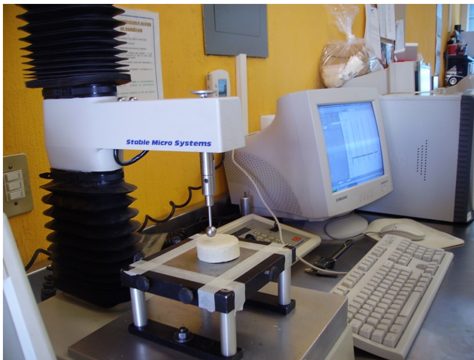
Figura 10. Prueba de adhesión y cohesión en masa.
