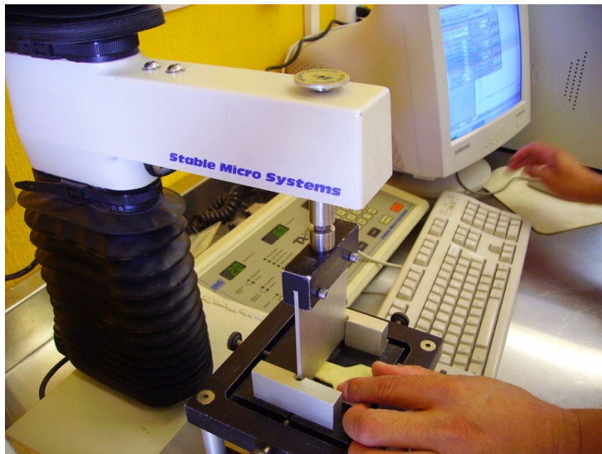
Figura 14. Prueba de resistencia al corte en tortillas.
