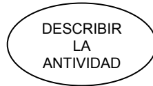
Figura A1.2 – Representación de un caso de uso para un Diagrama de casos de uso
