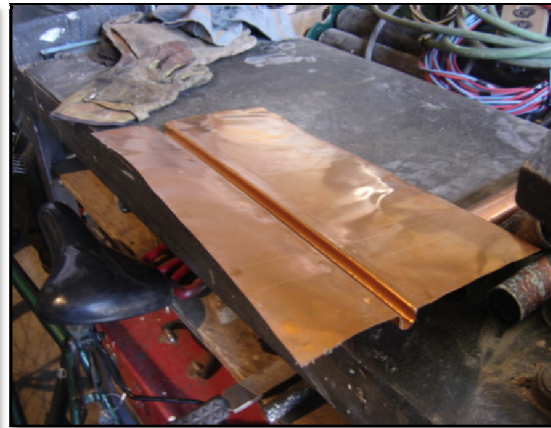
Figura 4-6. En las imágenes se esquematizan los 3 mecanismos de transferencia de calor (izquierda). Y una de las placas de cobre utilizadas para formar la totalidad de la placa absorbidora (arriba).
