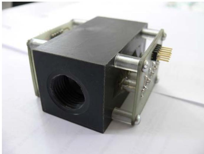
Figura 3.4 Fotografía del ensamble de la celda de flujo, la parte detectora y la parte del radiador de luz y selector de longitud de onda.
