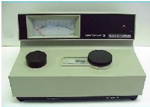
Figura 1.5 Espectrofotómetro Spectronic 21.
