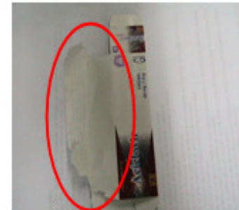
DEFECTO EN EL PEGADO
