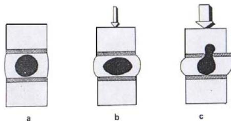
Figura 2. 13 Fisuración de la placa terminal. a) Al someter un disco a compresión se deforma, pero nunca se hernia; b) y c) la placa terminal se fisura por el centro y el núcleo protruye al interior del soma vertical en forma de hernia intraesponjosa [2.12].
