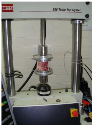
Figura 3. 7 Dispositivo de sujeción con espécimen montado en la máquina de ensayos.
