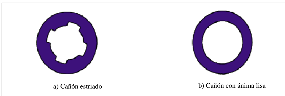
Figura I.6.- Esquema de tipos de cañón. [Molina-López, 1970]
