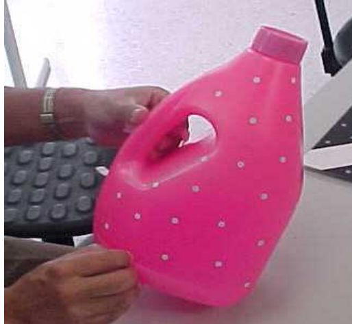
Fig. 3.5 Colocación de targets
