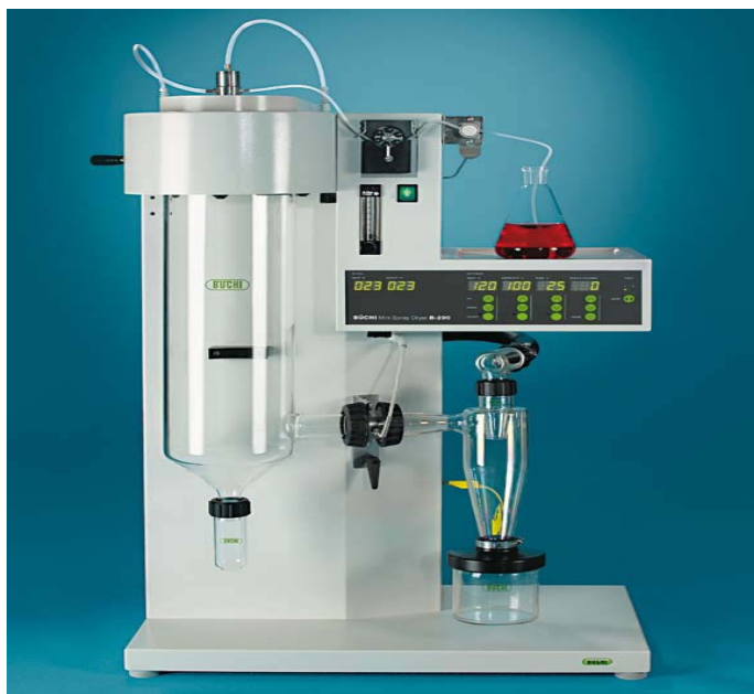
Figura 4.5.1. Mini Spray Dryer B-290 (BÜCHI, 2010)
