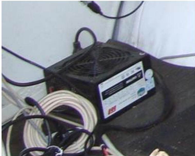
Figura 4. 5 Montaje de la fuente de alimentación de la cámara.
