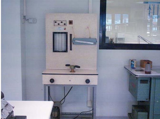
APARATO PARA REALIZAR LA PRUEBA DE PERMEABILIDAD AL AIRE
