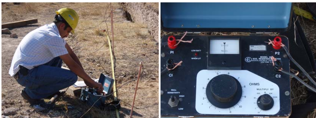
Fig. 115.- Medición de resistividad de terreno, en campo 47 (De izquierda a derecha, Foto1: Conexión y calibración de equipo; Foto 2: Lectura en equipo Vibroground)
