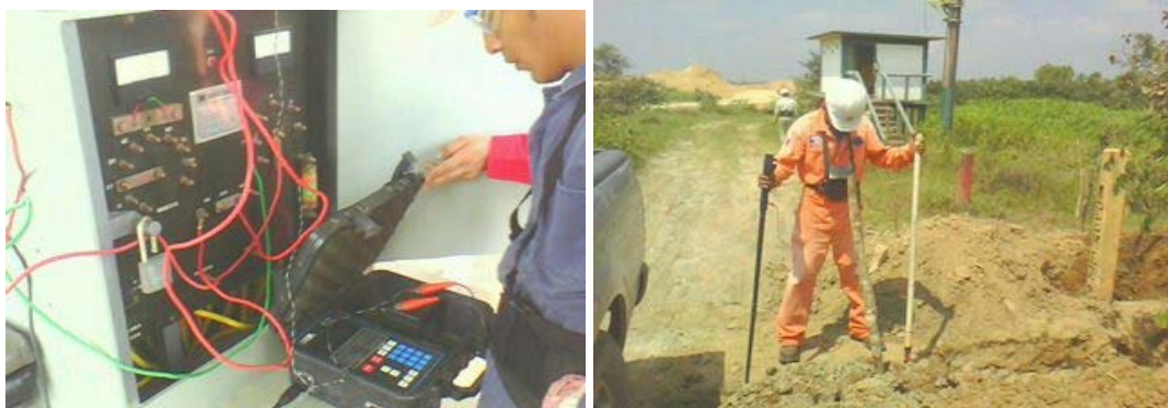
Fig. 114.- Gradiente de voltaje de corriente directa (DCVG) (De izquierda a derecha, Foto1: Conexión de interruptor de corriente, equipo On/Off; Foto 2: Recorrido de prueba DCVG)
