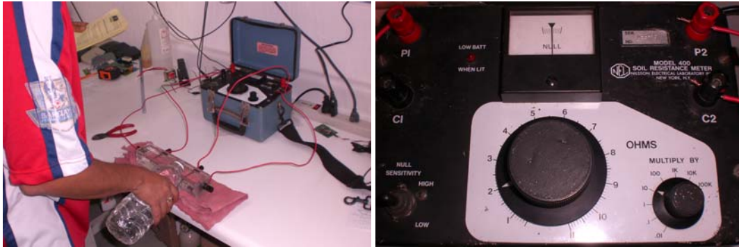
Fig. 116 48 . - Medición de resistividad de agua de mar utilizando caja de tierras, en laboratorio (De izquierda a derecha, Foto1: Conexión de equipo y llenado de caja de tierras; Foto 2: resultado de lectura en equipo Vibroground)
