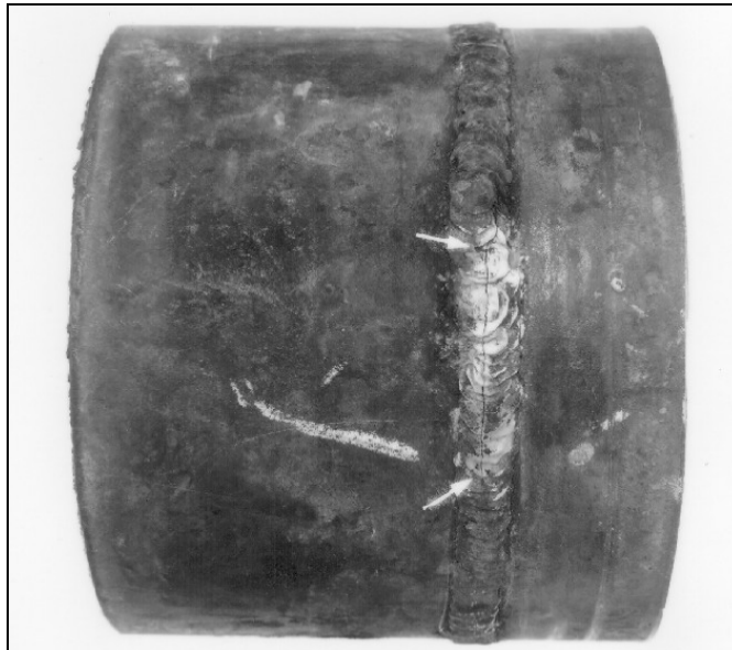
Figura 18.- Imágenes de fracturas ocasionadas por la combinación de una Soldadura defectuosa y la fatiga ocasionada por el servicio
