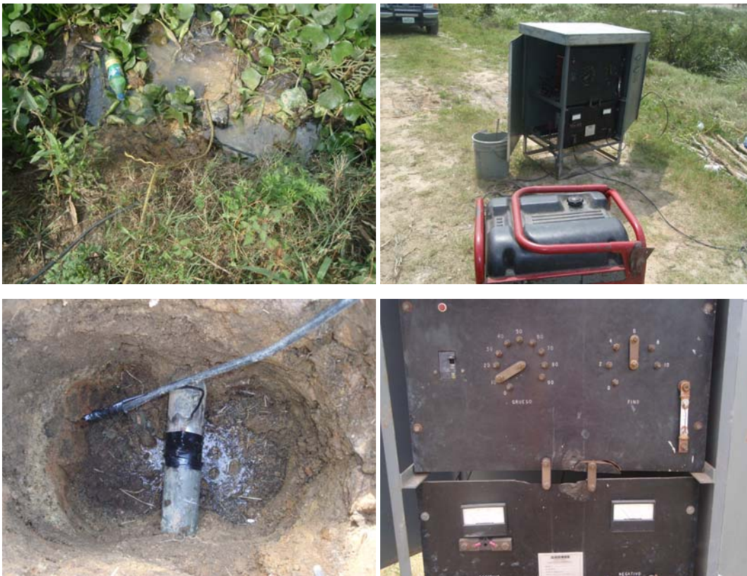
Fig. 120.- Prueba de requerimiento de corriente
