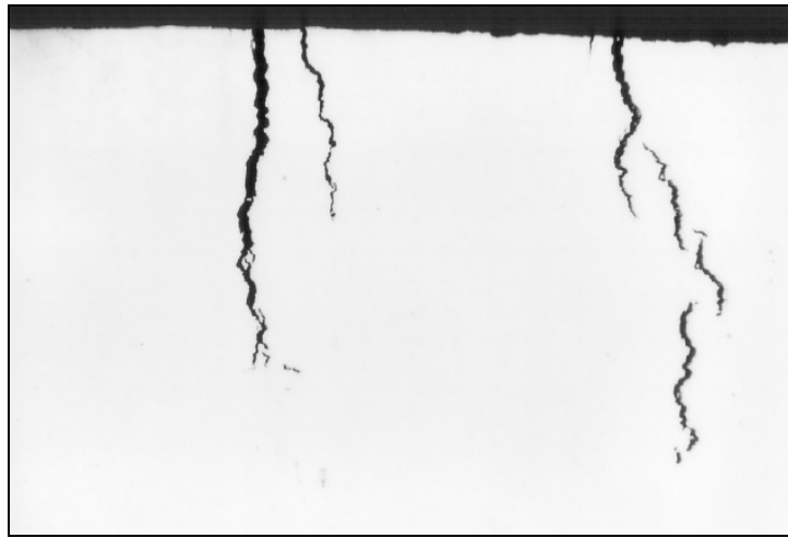
Figura 9.- Agrietamiento intergranular debido a corrosión con esfuerzo
