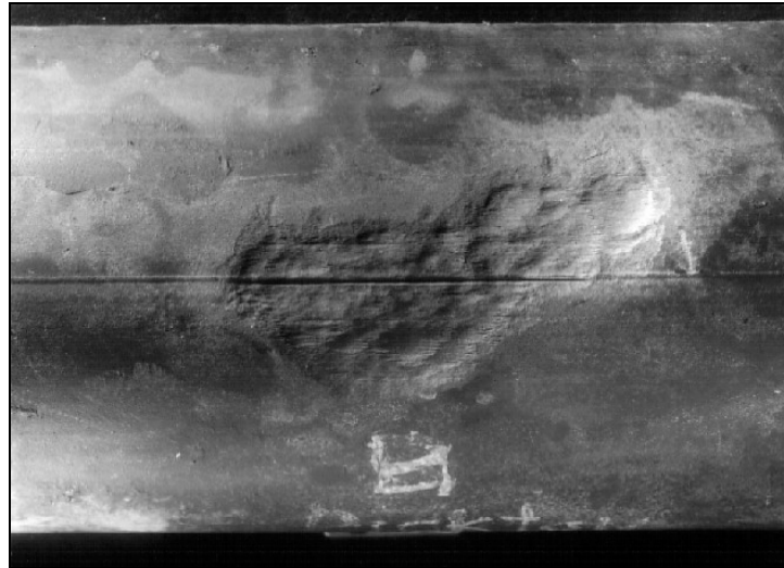
Figura 16.- Corrosión en ranuras
