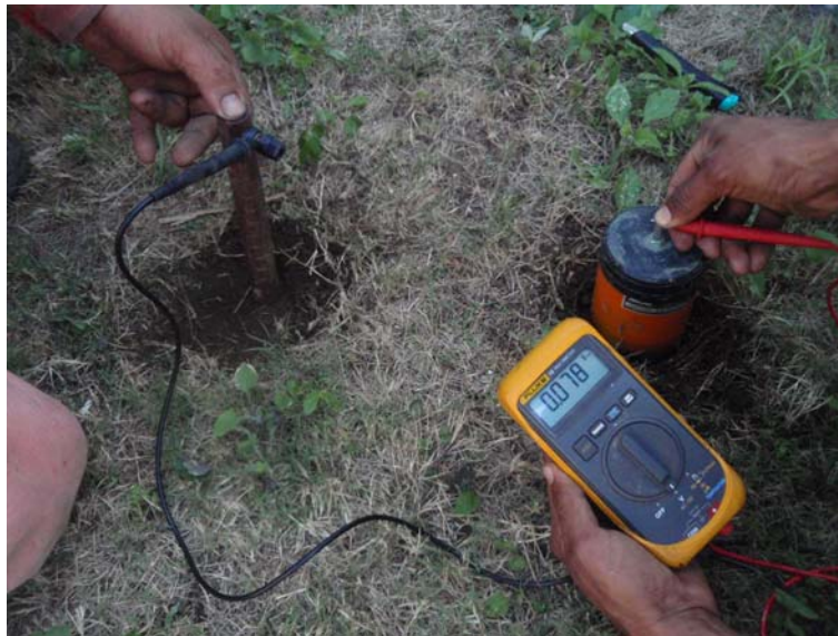
Fig. 119.- Medición de pH utilizando referidos a celdas de antimonio y de cobre/sulfato de cobre
