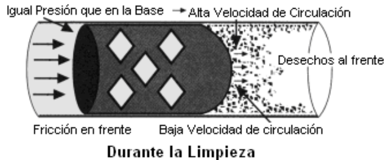
Figura 47.- Limpieza de ducto con Polly-pig
