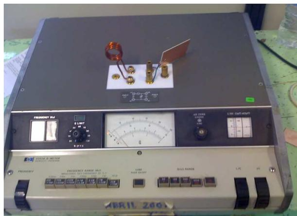
Figura 4.12 Medición de la capacitancia de la placa.
