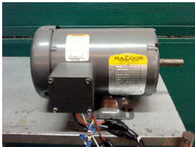
Fig. 6.9: Motor de inducción trifásico (Adaptado de [Sánchez, 2010]).
