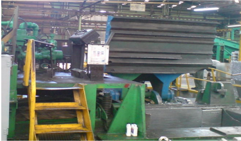
Figura 2.10 a) Muestra la fosa y el tablero de control de la maquina compactadora
