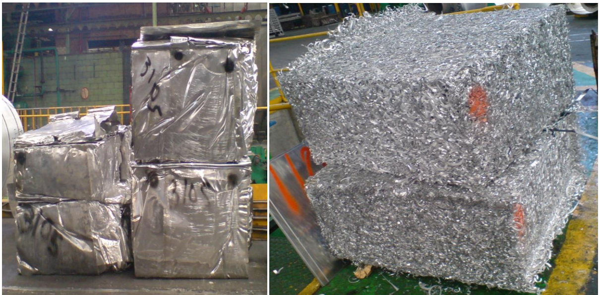
Figura 2.7 Se muestra en la parte izquierda una paca de desperdicio de aluminio como láminas o placas, y en la parte derecha una paca de aluminio de viruta
