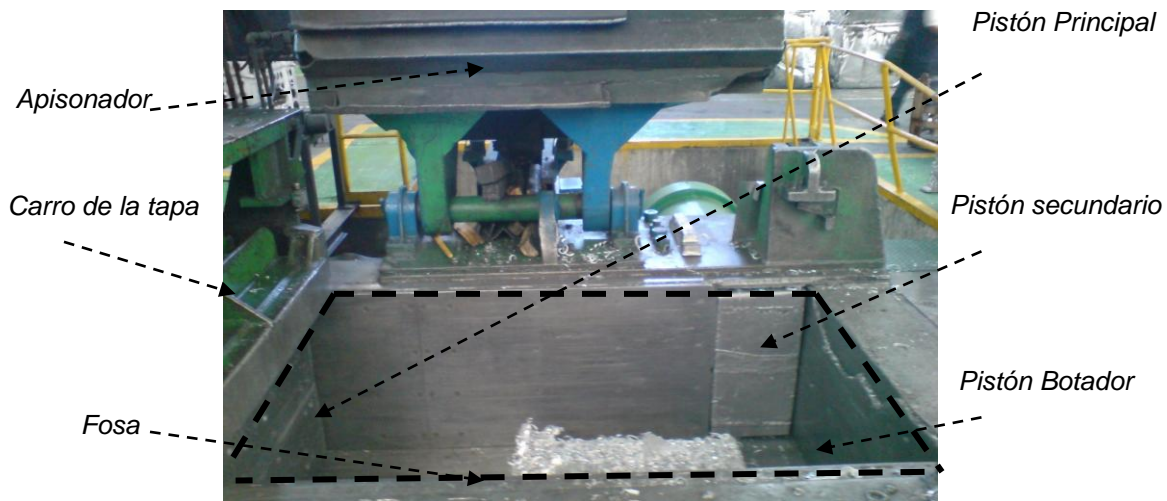
Figura 2.11 Se muestran las diferentes partes que componen la compactadora
