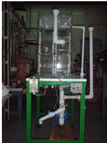
Figura 2.2 Sistema de bombeo en el reactor y regulador de nivel.
