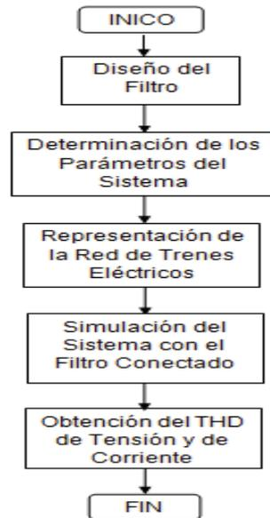
**Figura 3.4.** Diagrama de flujo para la simulación del filtro.
