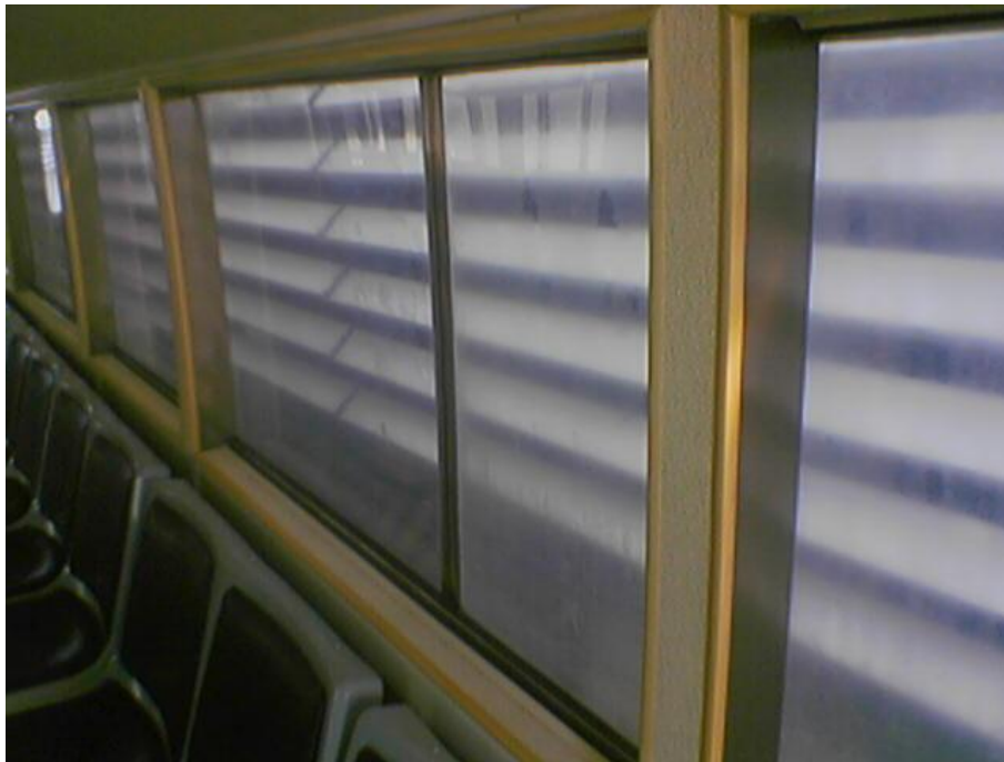
FIG.2.5. Imagen de los vidrios laterales deteriorados por acción del tiempo.
