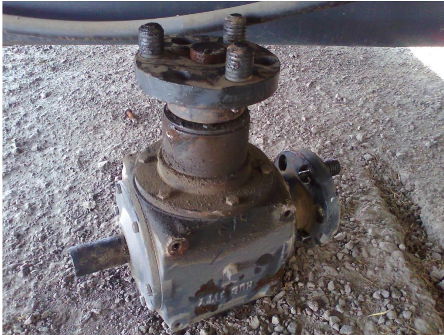
FIG.2.14. Vista de un Screw-Ball desmontado. En la parte superior la sección de acoplamiento con el tornillo sinfín y en el costado derecho la sección de acople con la toma de fuerza.
