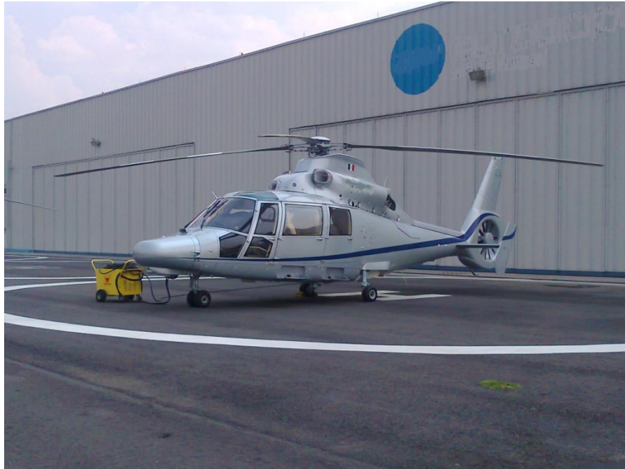
FIG.1.44. Pernocta de un Eurocopter Dauphin en pernocta. Hago notar la ausencia de balizamiento de protección para las palas del rotor principal así como la ausencia de conos de marcaje.
