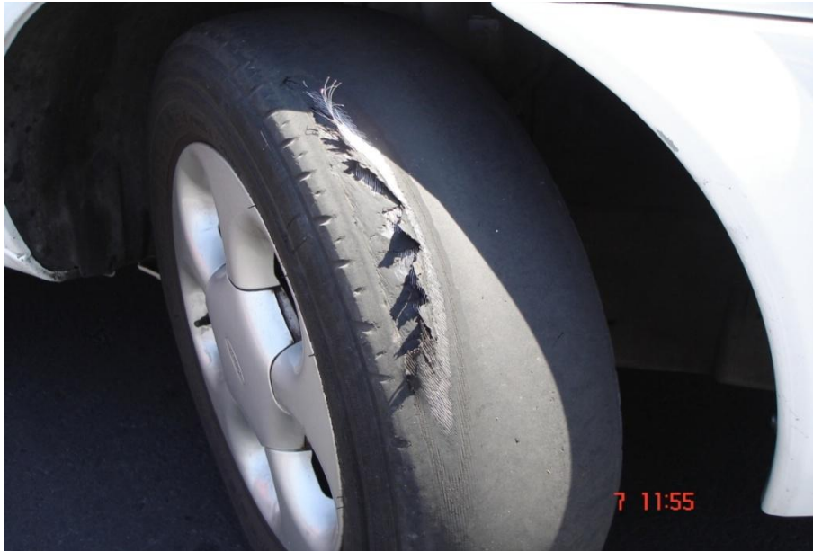
FIG.1.33. Neumáticos desgastados que ponen en riesgo la seguridad operacional.
