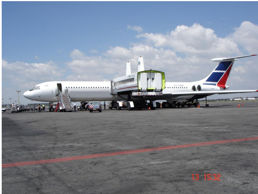
FIG.1.61. Dentro del ASA el acople de Salas Móviles para traslado de pasajeros (EDIFICIO-AERONAVE-EDIFICIO) y escaleras para suministros a la aeronave.
