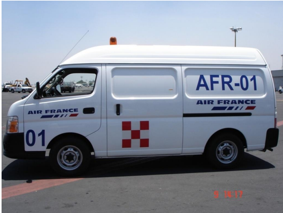
FIG.1.62. Detalle de Balizamiento superior de un vehículo convencional, bandera a cuadros rojo y blanco en costados, parte posterior y superior, además del faro cintilante giratorio color ámbar.
