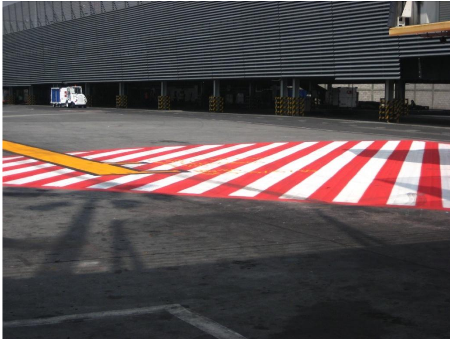
FIG.1.3. Señalamiento Horizontal ó marcas. Se muestra el área de seguridad de desplazamiento del abordador mecánico.
