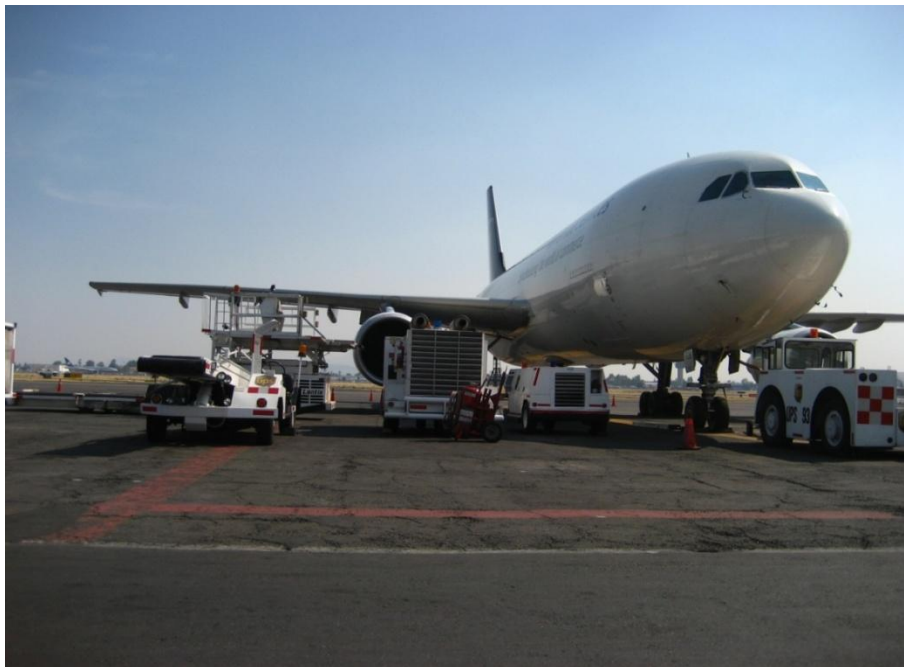
FIG.1.20. Acomodo del equipo de apoyo terrestre en proximidad a la aeronave: paralelo al eje longitudinal del avión y dentro de las áreas de estacionamiento de equipo. Airbus A-300F.
