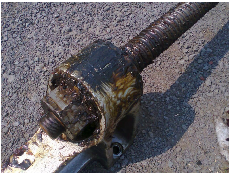
FIG.2.19. Grasa grafitada reseca y contaminada en toda la carrera de desplazamiento del tornillo sinfin.
