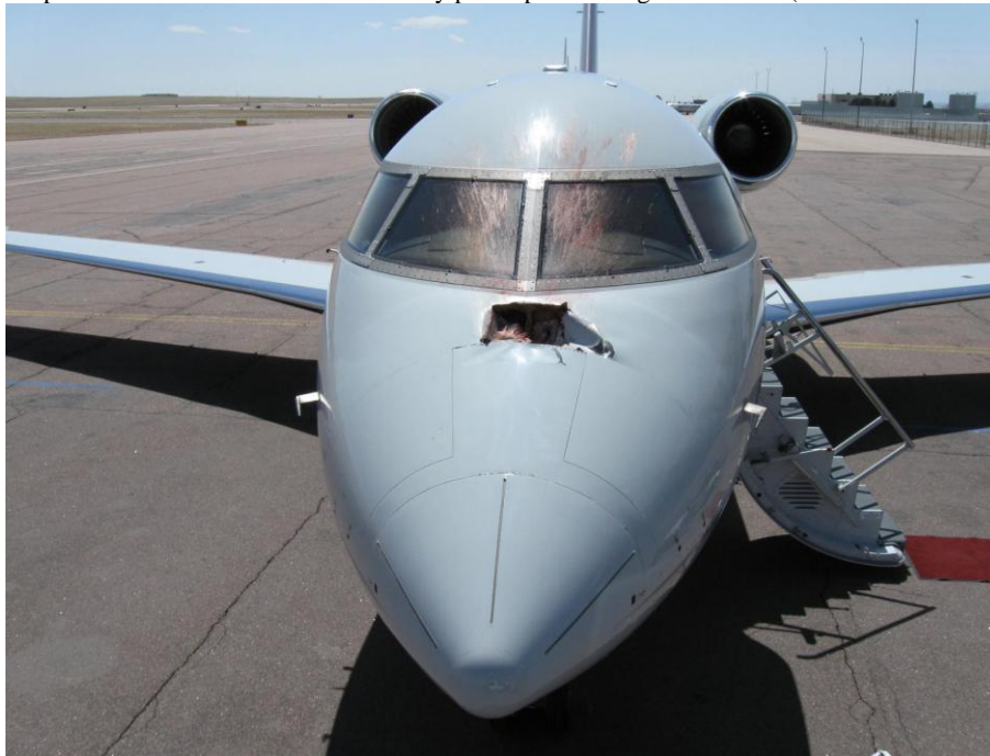
FIG.1.75. Al impacto con una parvada de aves, los daños son considerables poniendo en riesgo la vida y los bienes.
