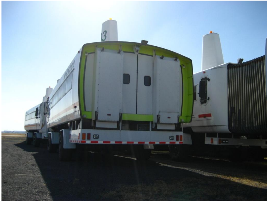
FIG.2.10. En la parte posterior de las salas móviles, la pintura verde reflejante, y balizamiento e imagen.
