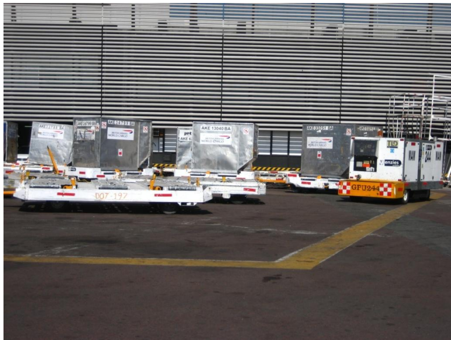
FIG.1.18. Área de Estacionamiento de Equipos de apoyo terrestre, delimitado en color amarillo.
