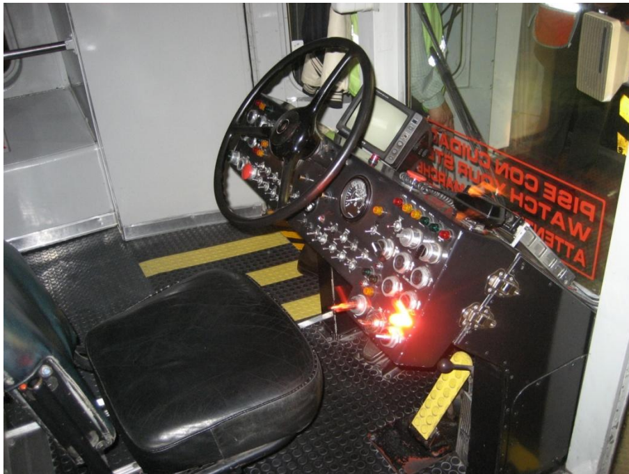
FIG.2.7. Tablero de control de las salas móviles.
