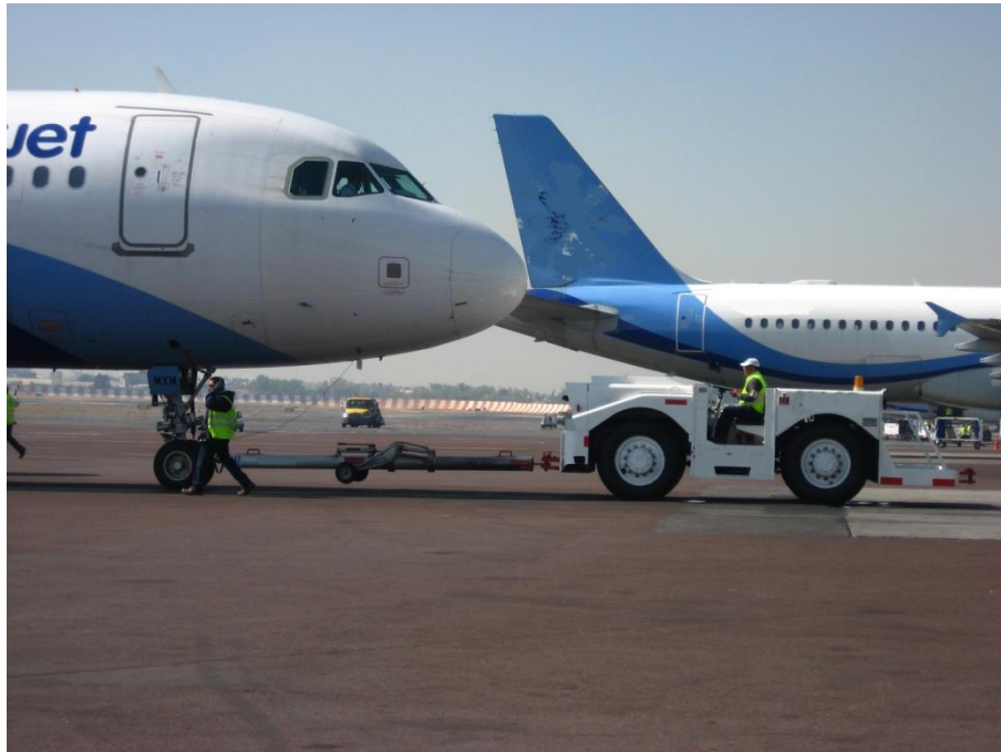
FIG.1.41. Maniobra de PushBack. En la Imagen Aeronave Airbus A-320-264 y Tractor de remolque Tipo T-300 Marca Stewart &Stevenson.
