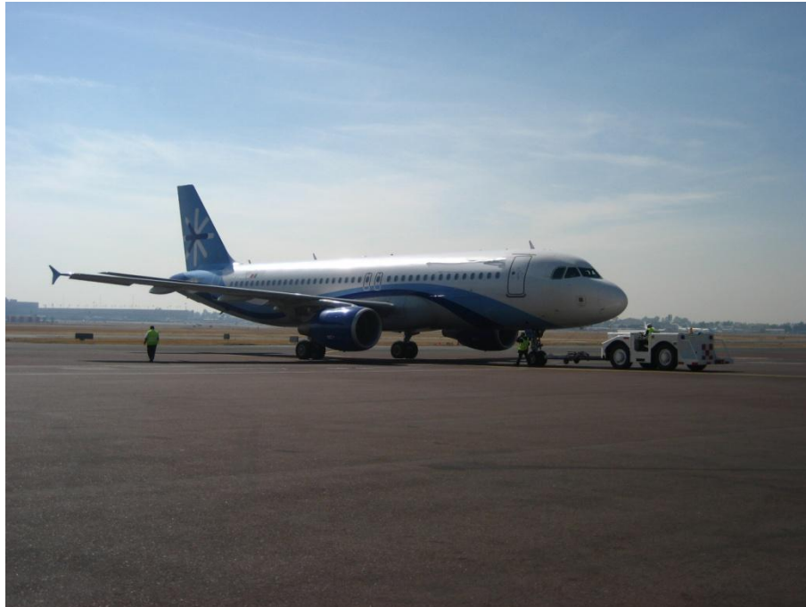
FIG.1.39. En la secuencia de encendido de motores el personal debe estar a una distancia mínima de 12 metros al frente de la toma de admisión. En la parte posterior es restringida la presencia de personas.
