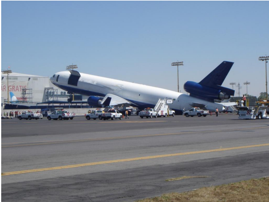
FIG.1.29. Incidente en la Plataforma Aduana con un MD-11-F. Errores en el procedimiento de descarga, falta de atención del personal de supervisión y descuidos del personal operativo provocaron el desbalance de la aeronave, que tuvo como consecuencia dos personas lesionadas y daños materiales cuantiosos.
