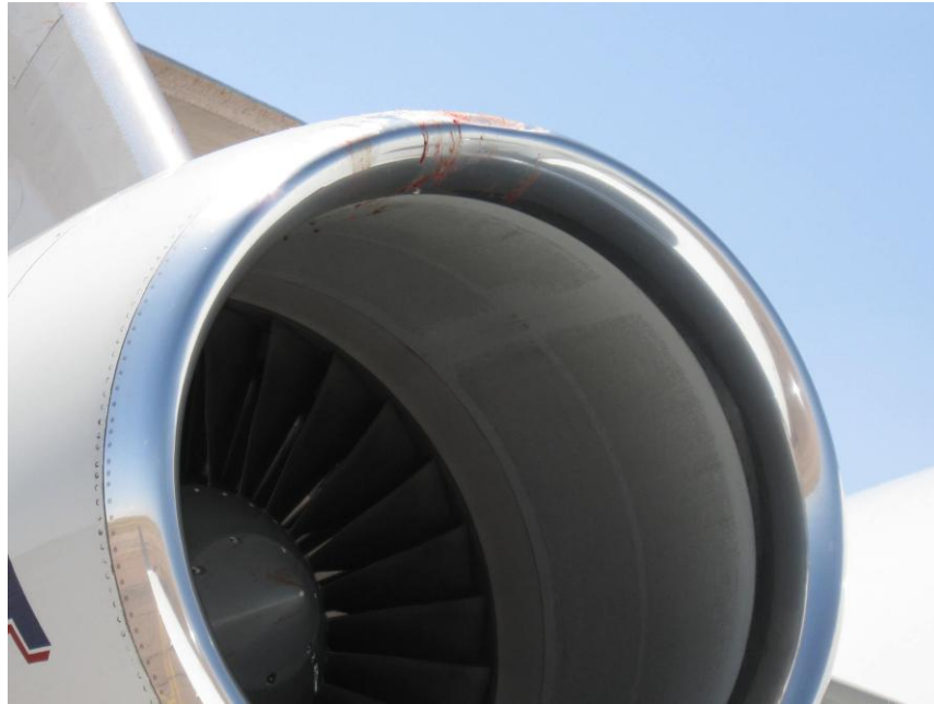
FIG.1.74. Daños producidos en un motor Pratt Whitney por impactos e ingesta de aves. (F.O.D. Fauna nociva)
