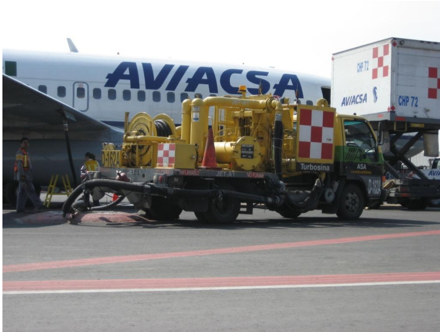
FIG.1.65. Suministro de Combustible a un Boeing 737-200. Suministro con caudal de 1300 litros por minuto de Turbosina (Jet A-1).
