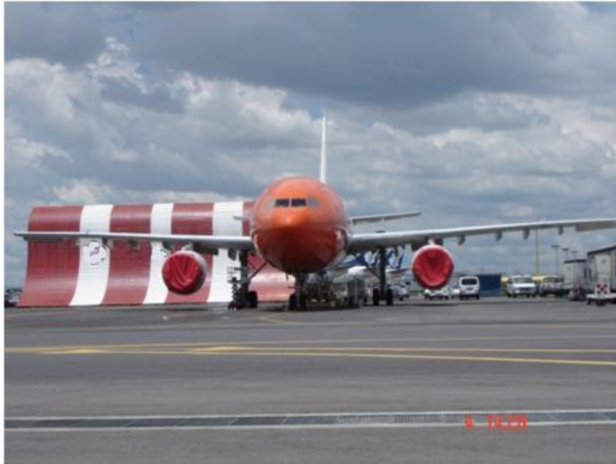
FIG.1.42. En 2do. Plano un deflector para la salida de gases en pruebas de corrida de motores. En primer plano un Airbus A-300FR.
