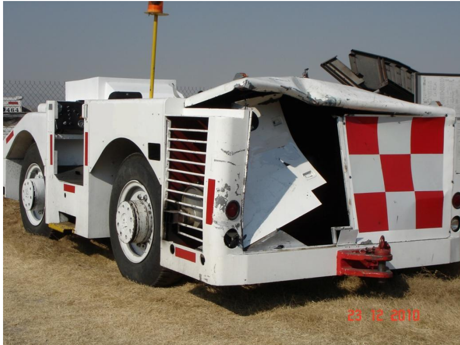
FIG.1.31. Daños provocados en un tractor para remolque de aeronave Hough T-300, el cual colisionó con una aeronave. Un error en el procedimiento de remolque de la aeronave provocó una ruptura de la horquilla de arrastre, por lo cual la aeronave continuó rodando hasta impactar con el tractor que se había detenido.
