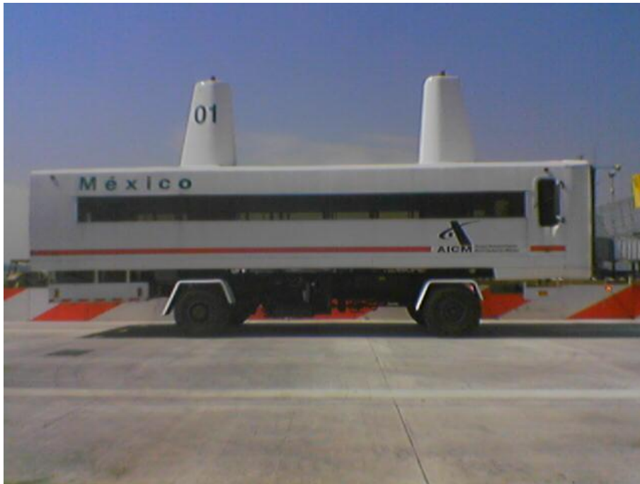
FIG.2.9. Vista lateral de la sala destacando el número económico y parte del balizamiento.
