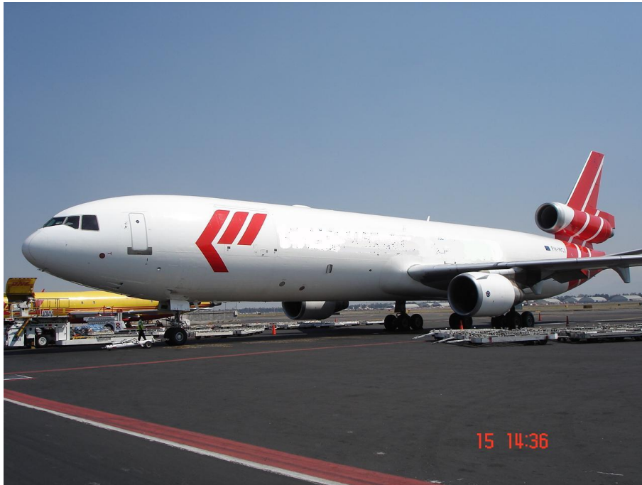
FIG.1.60. Colocación del equipo de apoyo en espera de las maniobras de descarga de la aeronave.
