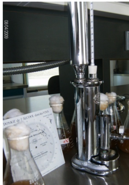
Figura 27:(A) Esquema del ebullómetro Dujardin -Salleron (B) Foto del ebullómetro en la que se observa el disco graduado para el cálculo del porcentaje de alcohol.
