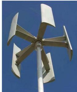
**Figura 2.5** Aerogenerador tipo Panemonas [43].
