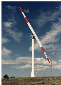
**Figura 2.9** Aerogenerador de dos Palas [42].
