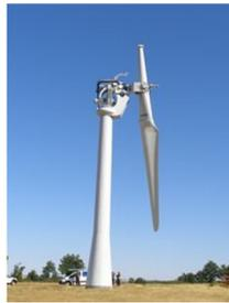
**Figura 2.8** Aerogenerador de una Pala [44]
