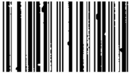
Figura 8.17 Manchas y huecos
