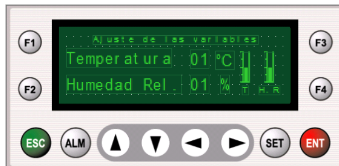
Figura IV.20 Pantalla para ajustar los valores de consigna de las variables de proceso en la HMI (Pantalla No.3). (Ver referencia [28]).
