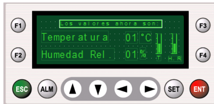
Pantalla No.2: Muestra los valores actuales de las variables, en cada momento.
