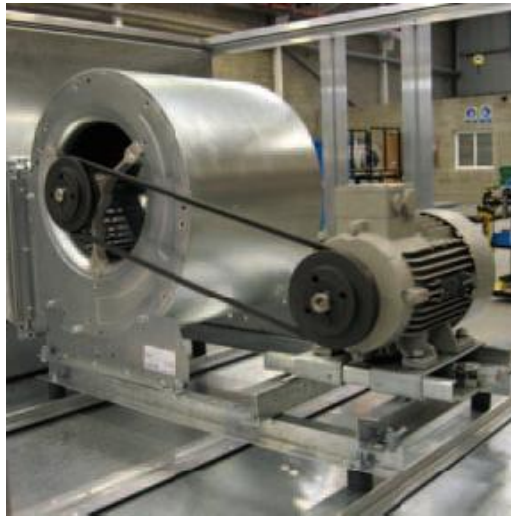
Figura III.3 Conjunto moto-ventilador de una UMA. (Ver referencia [13]).
