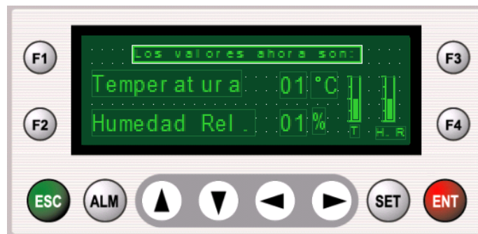
Figura IV.19 Pantalla para mostrar valores actuales de variables de proceso en la HMI (Pantalla No.2). (Ver referencia [28]).
