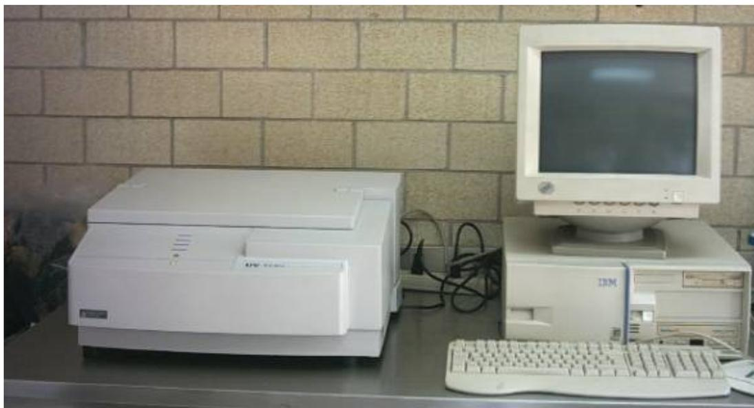
**Figura 3.2 Equipo utilizado en espectrofotometría de UV-VIS**
