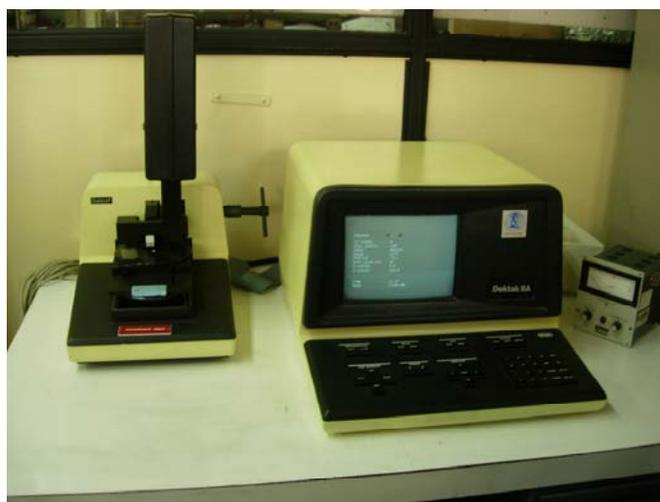
Figura 4.3. Perfilómetro Dektak IIA del departamento de Física Avanzada.
