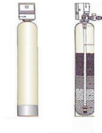
FIG. 5. FILTRO DE CARBÓN ACTIVADO Y CORTE
