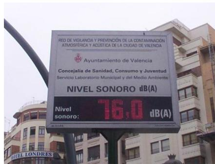
Figura 1.7 Mediciones con un sonómetro en una avenida de una ciudad.
