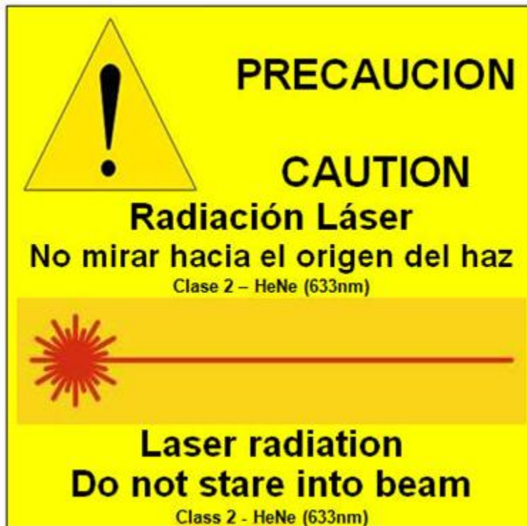
(Figura A.3.3.5. Etiqueta de precaución de láser clase 2.)
