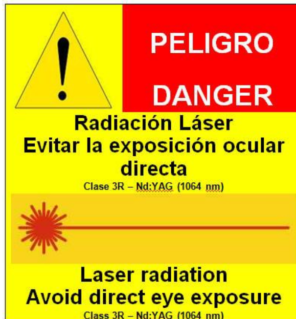
(Figura A.3.3.7. Etiqueta de precaución de láser clase 3R Nd-YAG.)
