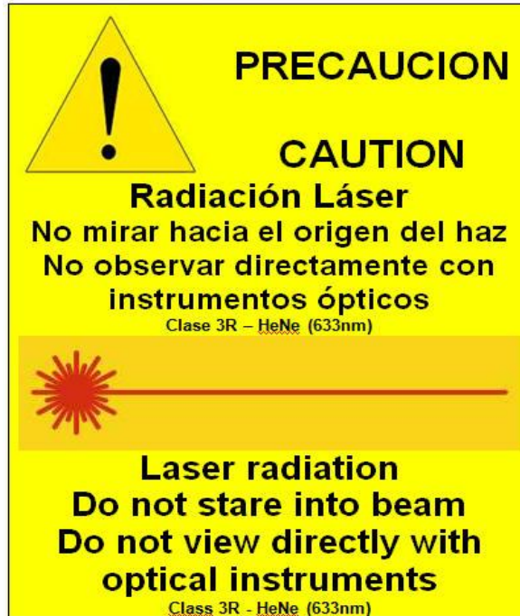
(Figura A.3.3.6. Etiqueta de precaución de láser clase 3R HeNe.)
