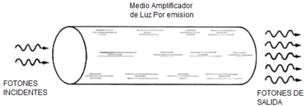
(Figura 1.5.4.1. Amplificación de luz por medio de emisión estimulada.)
