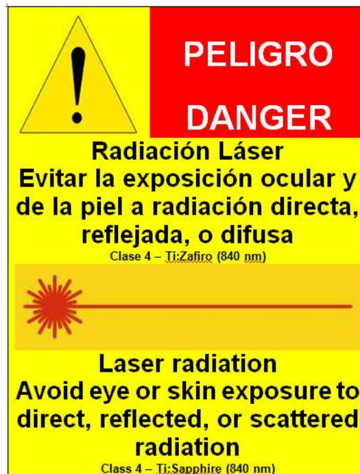
(Figura A.3.3.9. Etiqueta de precaución de láser clase 4.)
