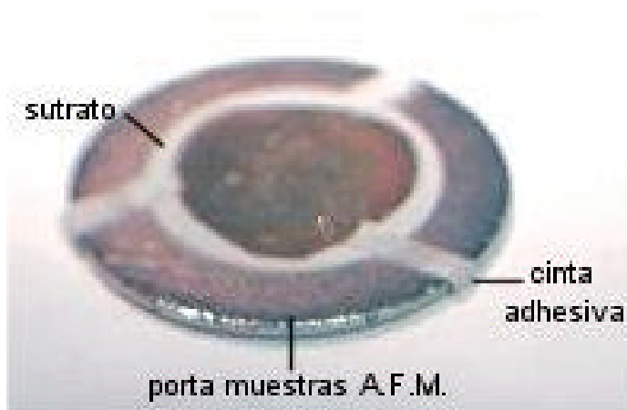
Figura 5.1 Imagen que muestra la colocación adecuada de la cinta adhesiva del sustrato al porta muestras de MFA
