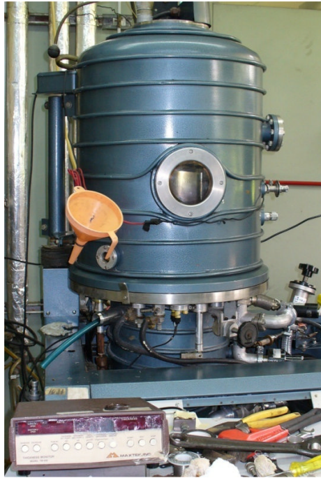
Figura 3.2 fotografía de la evaporadora de la E.S.F.M. utilizada para el depósito de la película de oro.
