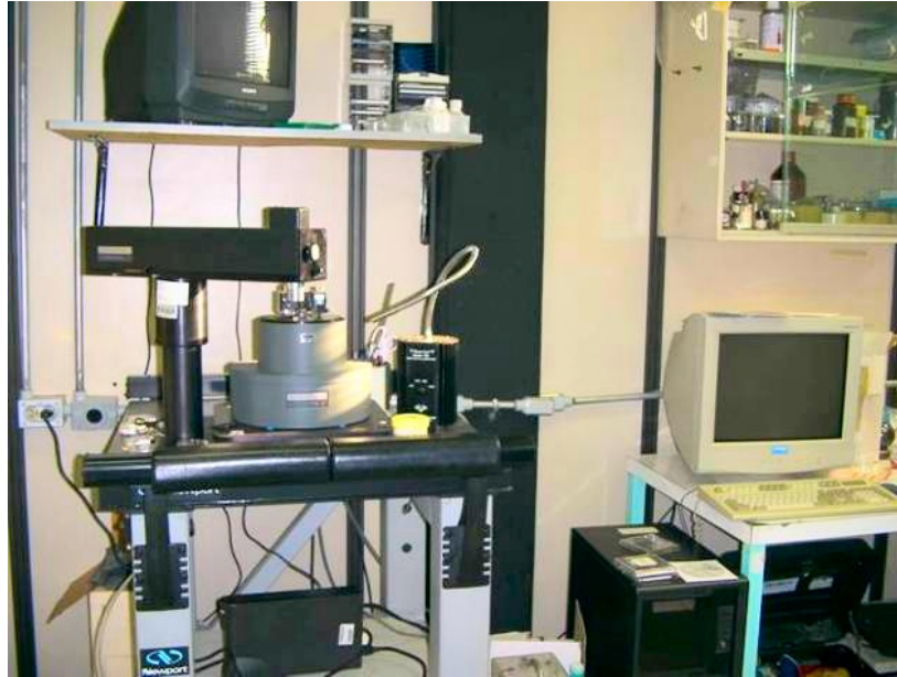
Figura A.2 Imagen fotográfica del microscopio de fuerza atómica empleado para la técnica de rayado y caracterización de las muestras.
