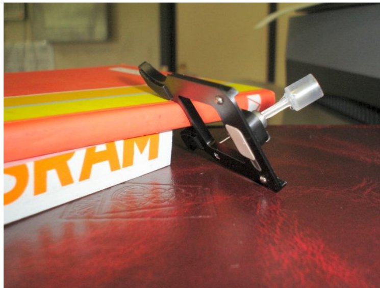
Figura 3.4 Fotografía del montaje de la jeringa de insulina recortada, utilizada como punta para STM.
