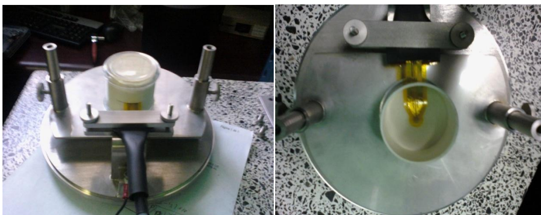
Figura 3.17 Sensor y porta muestra Hot disk.
